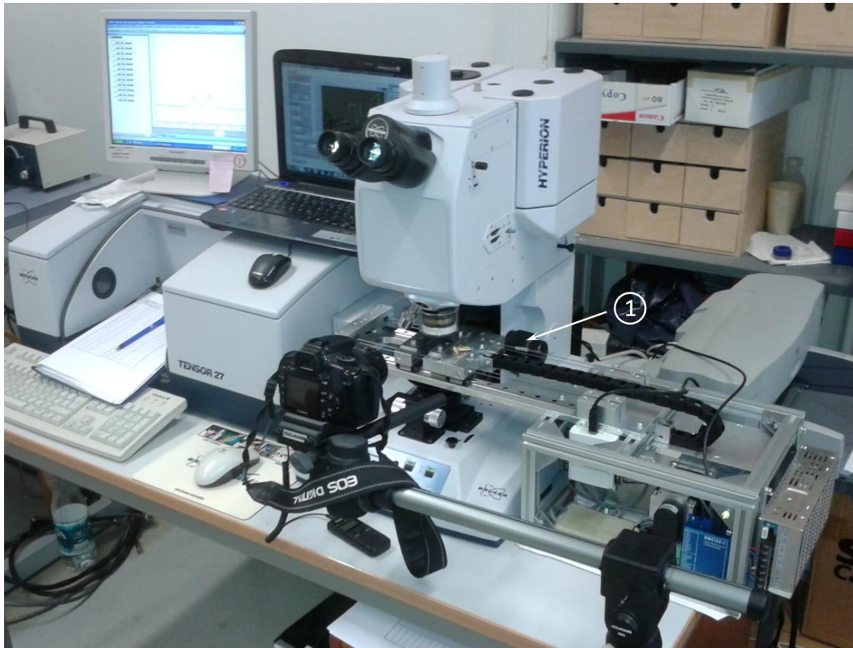
Abb. 83: Fertige Zugprüfeinrichtung im Praxisbetrieb
