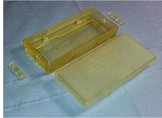
Abb. 57: Gehäuse für DMS-Messverstärkerschaltung
