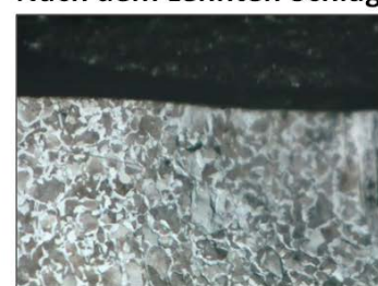
Abbildung 32: Bildung des Deformationsbereichs anhand von Gefügeaufnahmen
