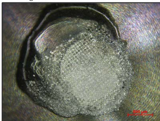
Abbildung 77: Verstopfen der Stößelstruktur durch Verwendung von Trockenschmierstoff
