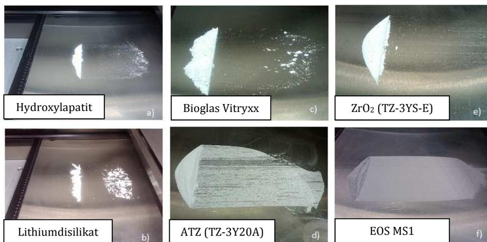
**Abbildung 32: Vorversuch (Fließverhalten) mit verschiedenen keramischen Werkstoffen im Vergleich mit dem Standardmaterial EOS MS1**
