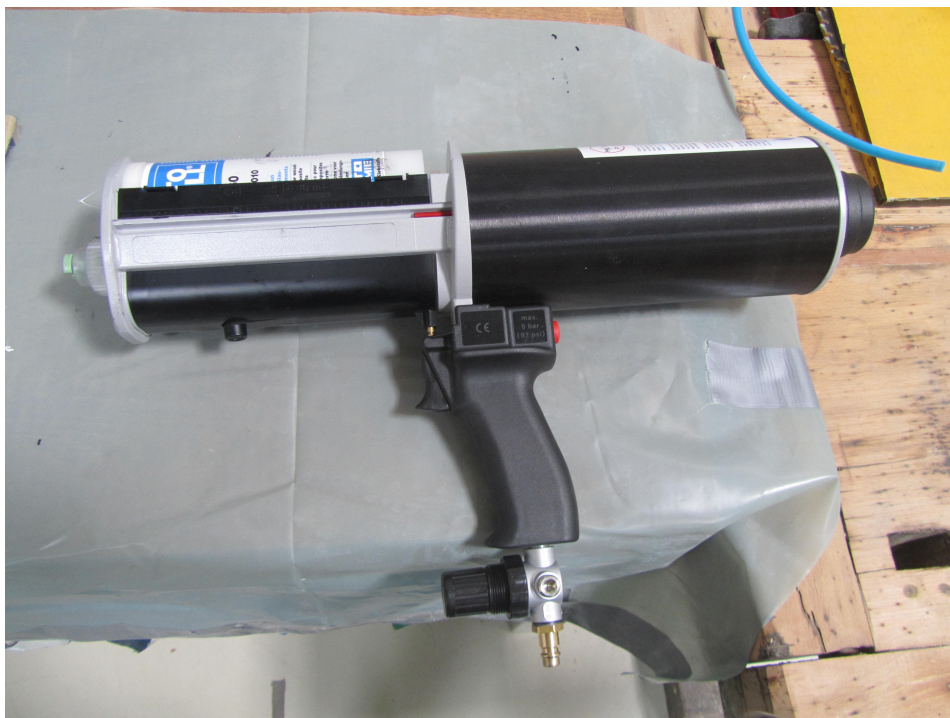
Abb. 3.3.: Druckluftpistole mit eingespannter Silikonkartusche
