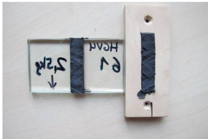
Abb. 3.24.: Bruchbild einer Probe 92 Tage belastet mit 0,04 \text{ N/mm}^2
