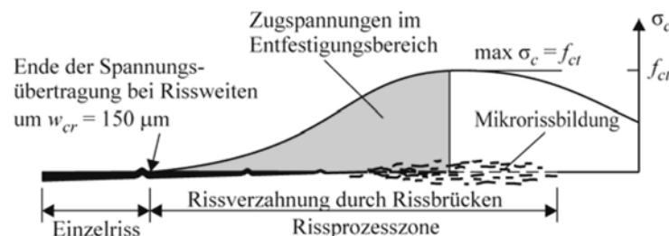
Abbildung 2.7 – Rissprozesszone [55]
