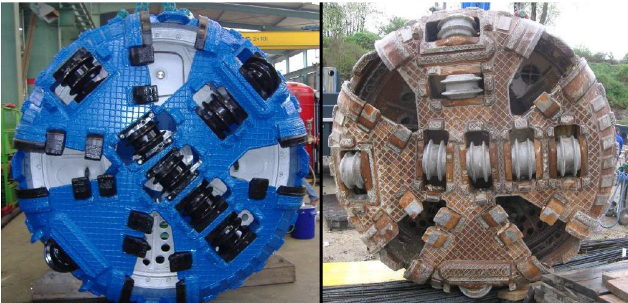
Abbildung 4.4: Schneidrad vor und nach erster Haltung [24]
