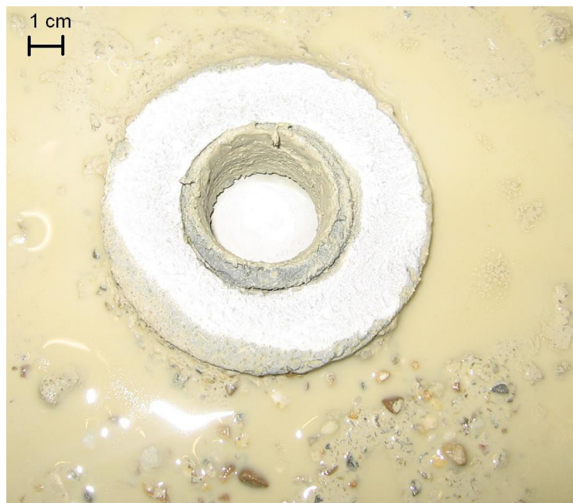
Abbildung 5.7: Nut und Gleitlagerring am Boden des Versuchtopfes
