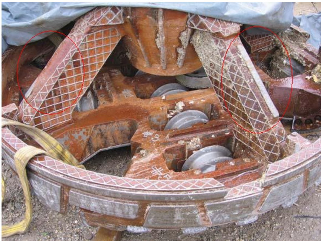
Abbildung 4.8: Schneidradrückseite mit Brecherleisten (rot umrandet)
