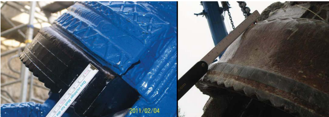
Abbildung 4.7: Verschleißbild der Räumer [24]
