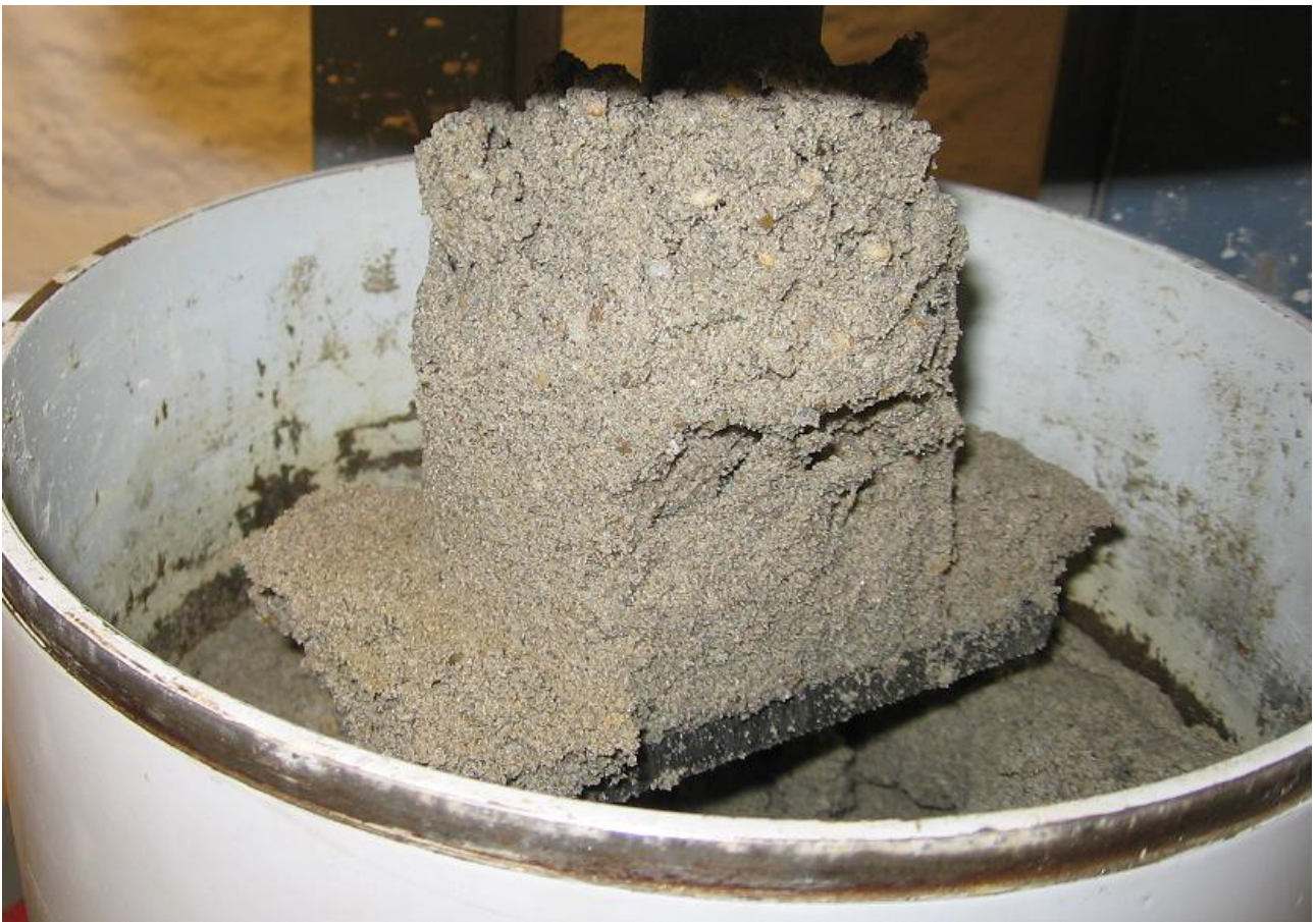
Abbildung 5.10: Hohe scheinbare Kohäsion des Feinkieses bei Versuch Nr.3
