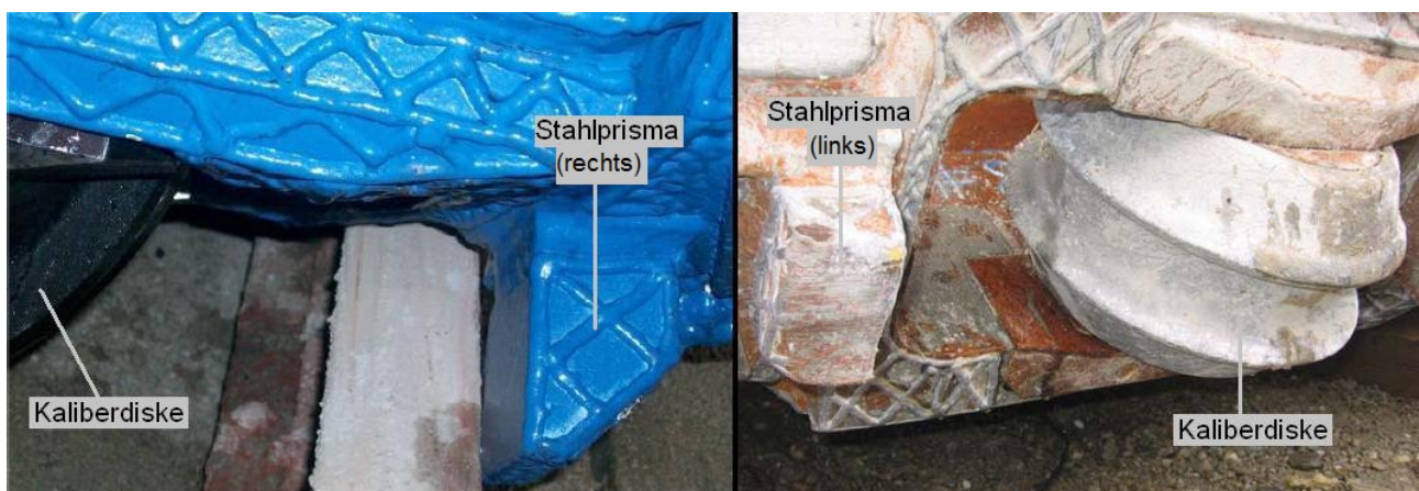
Abbildung 4.5: Verschleiß an Kaliberdiske und Stahlprisma [24]
