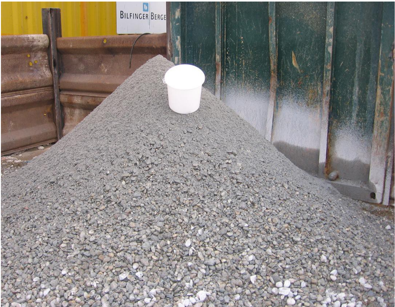
Abbildung 5.1: Schüttkegel der Separieranlage
