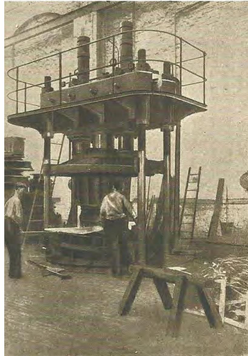
Abb. 46 Einführen des Blechs unter die Presse
