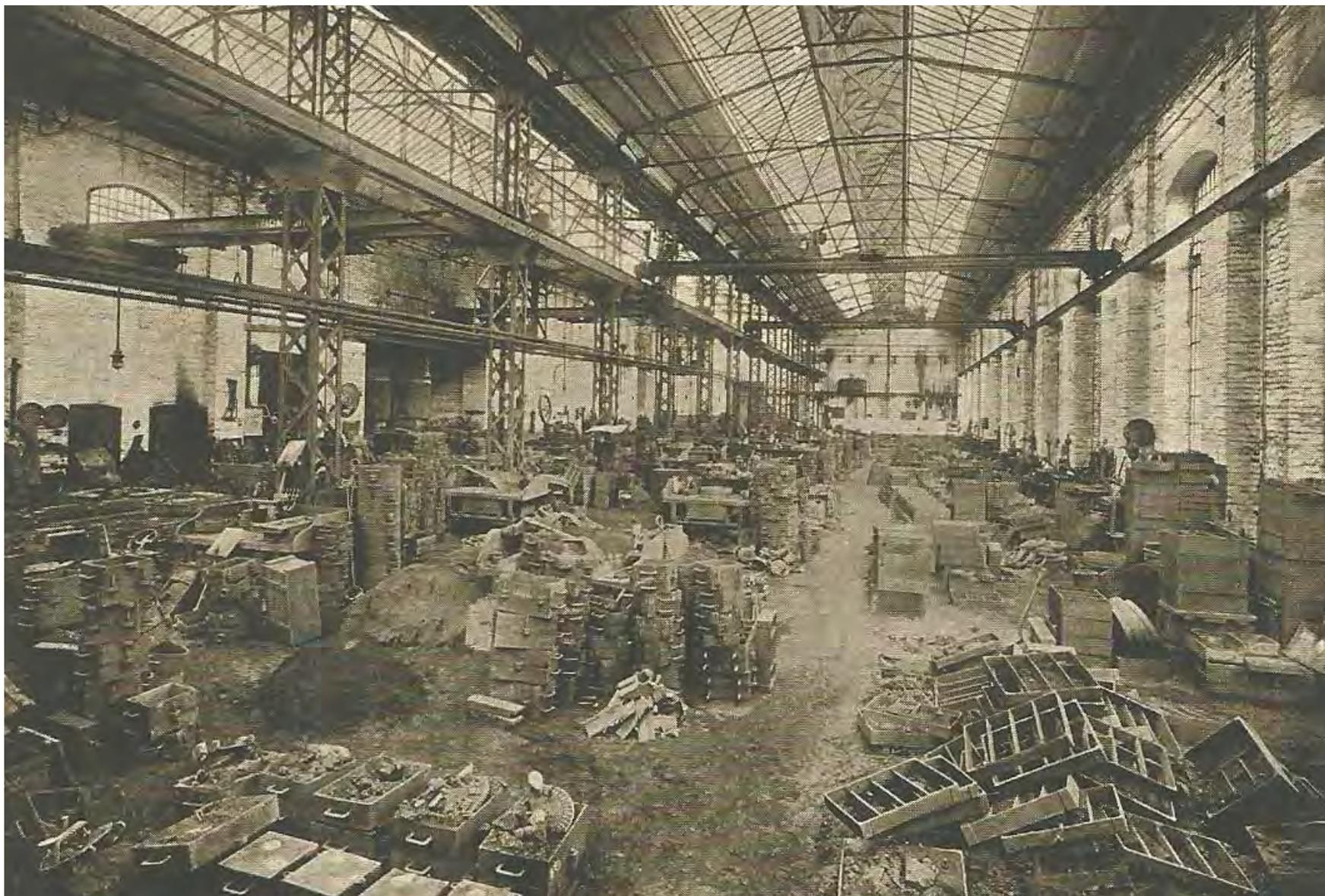
Abb. 37 Bereich der Hand- und Maschinenformer in der Graugießerei (VII)
