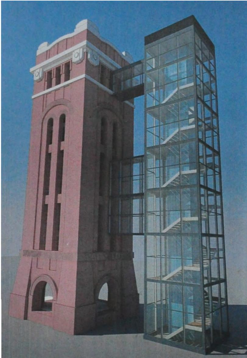
Abb. 175 Entwurf für den Wasserturm mit Erschließungskörper
