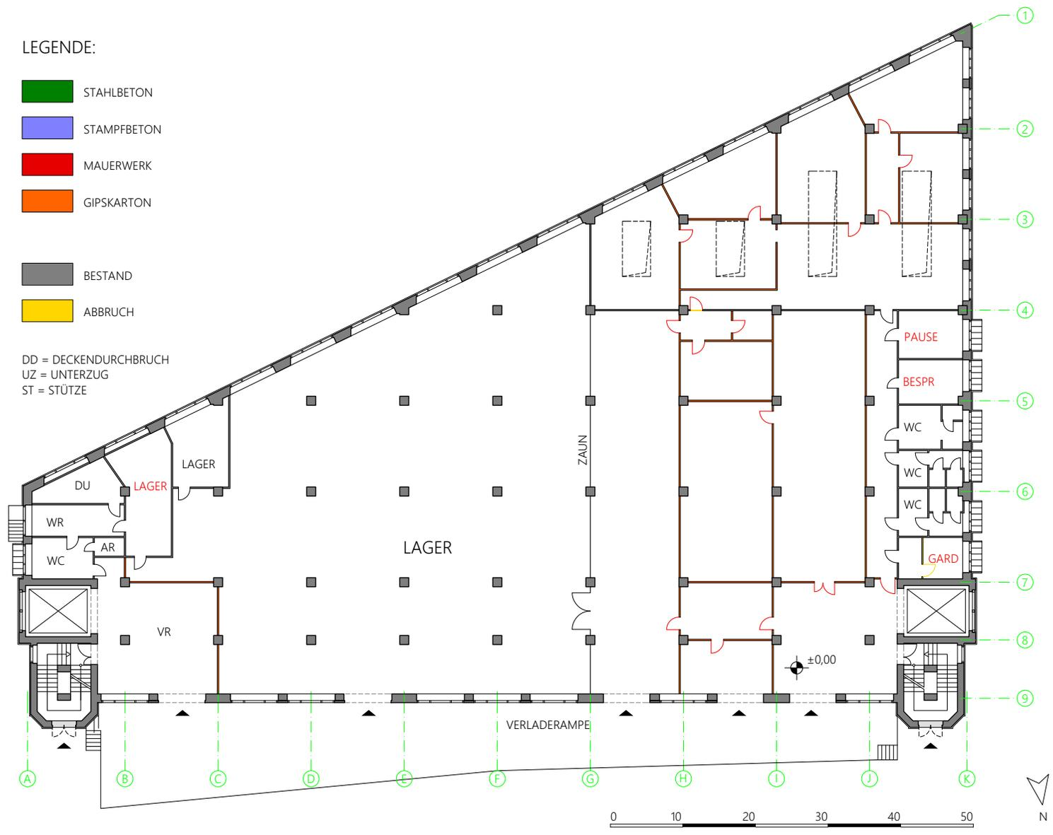
Abb. 108 Bauphasenplan 2008: Erdgeschoß des Maschinenmagazins
