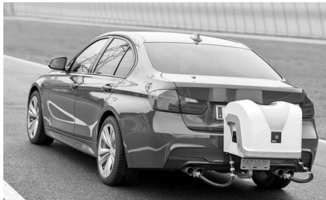
Abbildung 38: PEMS – Portable Emission Measurement System<sup>308</sup>
