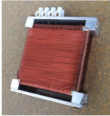
Abbildung 4.1: Eine DC-Spule wie sie als Hochfrequenzflipper zum Einsatz hätte kommen sollen. Als Hochfrequenzflipper ungeeignet aber für konstante  $\frac{\pi}{2}$ - Flips im Experiment eingesetzt.
