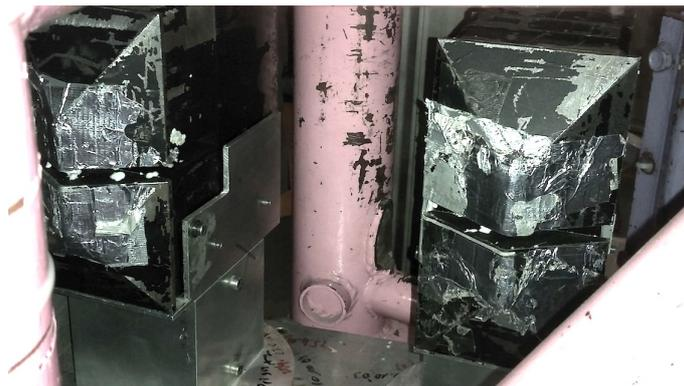
Abbildung 3.5: Die im Experiment verwendeten Magnetprismen. Sie befinden sich direkt am Neutronenausgang nach dem Monochromator und sind aufgrund ihrer Masse und Feldstärke direkt an den Stahlträgern die das gesamte Experiment tragen fixiert
