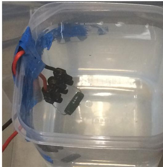
Abbildung 4.5: Der im Experiment verwendete, provisorisch wassergekühlte  $2.7 \Omega$  Leistungswiderstand
