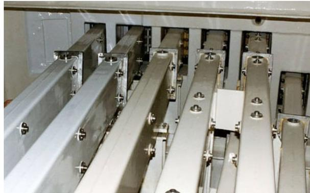
Abbildung 3.3: Bündel an Neutronenleitern am Reaktorausgang, [www.ill.eu](http://www.ill.eu)
