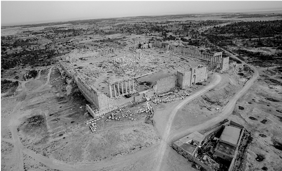
Abb. 57: Luftbild des Bel-Heiligtums nach der Sprengung durch den Islamischen Staat, 2016. Das Eingangsportal blieb als einziges Bauteil der cella bestehen, da man es in den 1920er Jahren mit Stahl armiert hatte.
