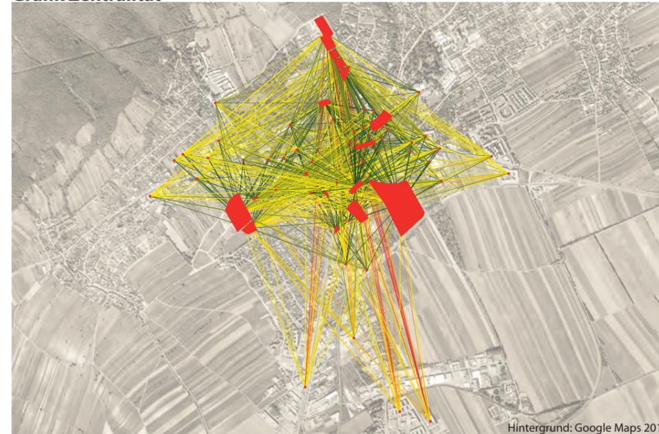
Für jeden der möglichen Bauplätze wird die Zentralität mittels der Abstände zu den Synergiefunktionen der Umgebung errechnet und die Bauplätze gereiht.
