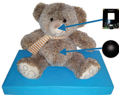
Abbildung 6.11: Technik im Bär: RFID-Reader im Kopf und Lautsprecher im Bauch.
