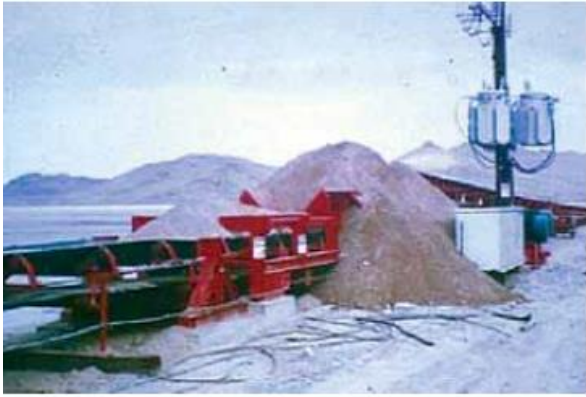
Abbildung 3: Verstopfung und Verschüttung [6]
