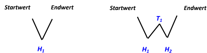
Bild 38: Identifikation & Herauslösen einzelner Überfahrtsereignisse anhand der Charakteristik der lokalen, relativen Maxima
