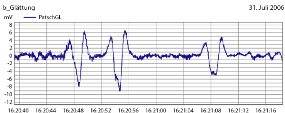
Bild 27: Geglättetes Beschleunigungssignal am BrückeKragarm zur gezielten Erkennung von LKW-Überfahrten für den Beschleunigungs-Sensor Patsch
