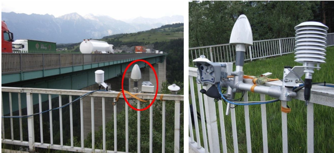
Bild 125: Video basierte Erfassung der Einwirkung sowie meteorologische Mess-Station am Widerlager Schönbögen
