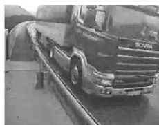
Bild 34: Schritt 1/2 (OBEN) - Ermittlung des einwirkenden LKW-Gewichtes anhand der registrierten Überfahrtsgeschwindigkeit sowie der korrespondierenden, generierten Kragarmverformung
