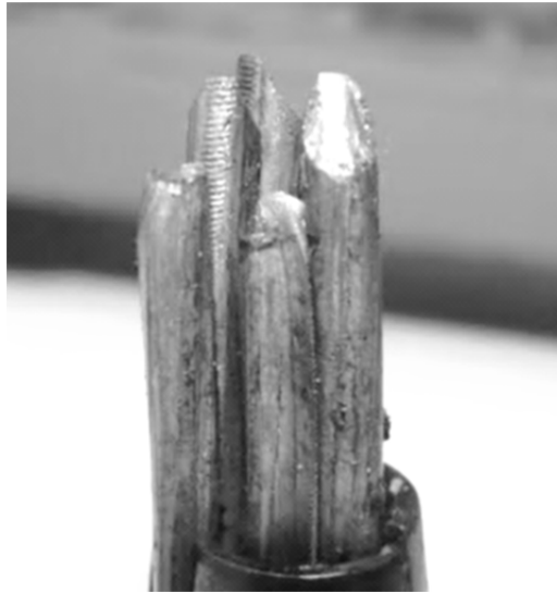
Abb. 3.4: Unterschiedliche Bruchflächen in einem statischen Zugversuch
