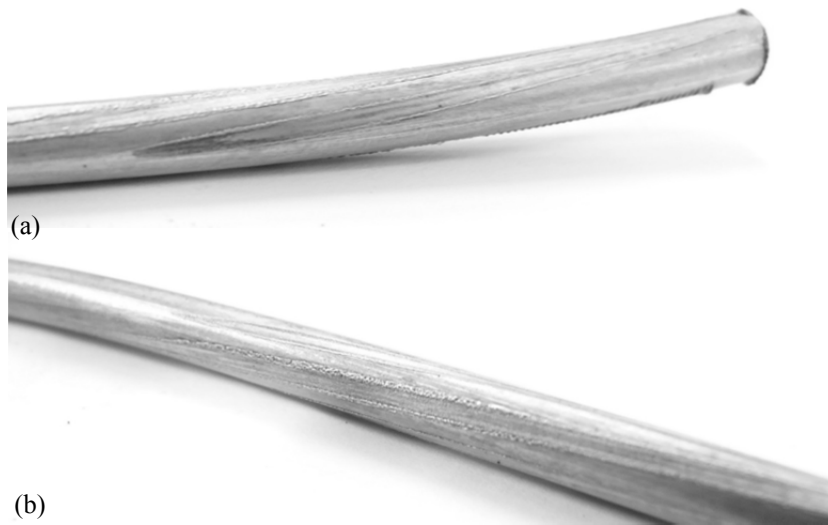
Abb. 4.6: Abplattungszonen nach Zugversuch Außendraht (a) Kerndraht (b)
