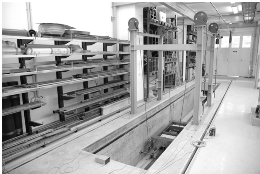
Abb. 2.2: Dauerschwing-Resonanzprüfmaschine (TU Wien)
