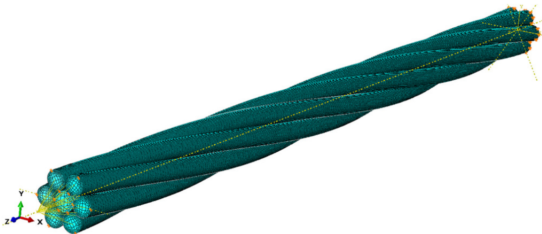
Abb. 4.1: FE-Modell Freie Länge (KIZ-Frei)
