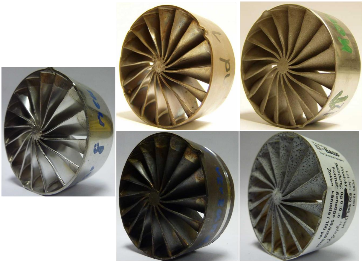
Abbildung 6.6: Mischer der gleichen Geometrie mit unterschiedlich behandelter Oberfläche.
