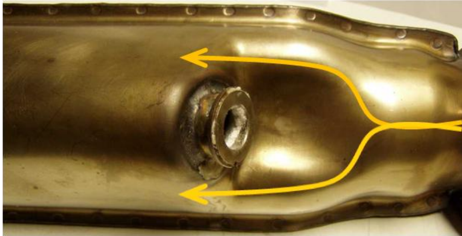
Abbildung 6.38: Geradrohr mit symmetrischer Geometrie zur Abgasführung im Bereich des Dosierstutzens.
