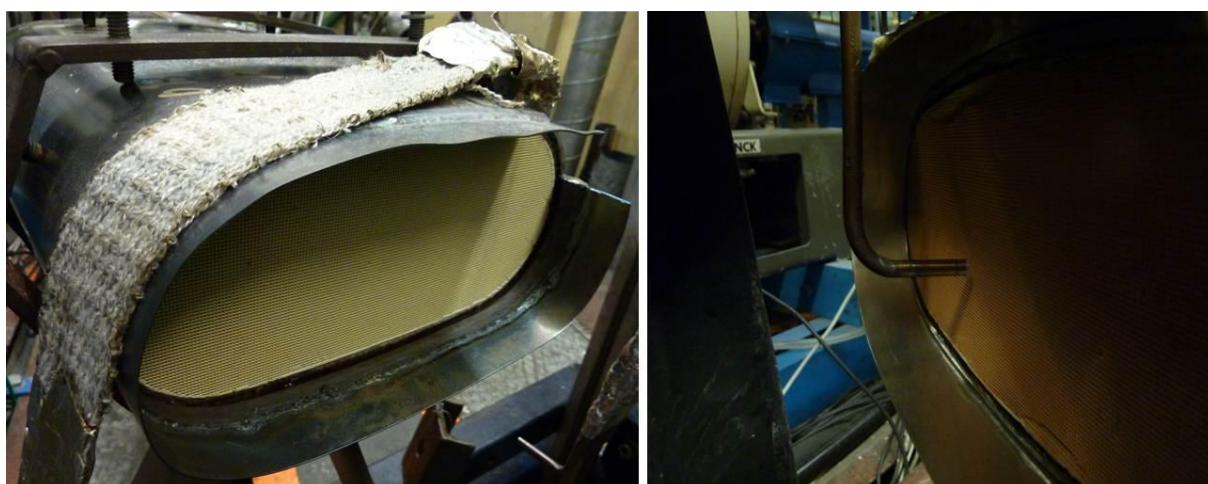
Abbildung 5.5: Offenes System – eine Messsonde rastert den Katalysatorquerschnitt mit beliebiger Auflösung ab.
