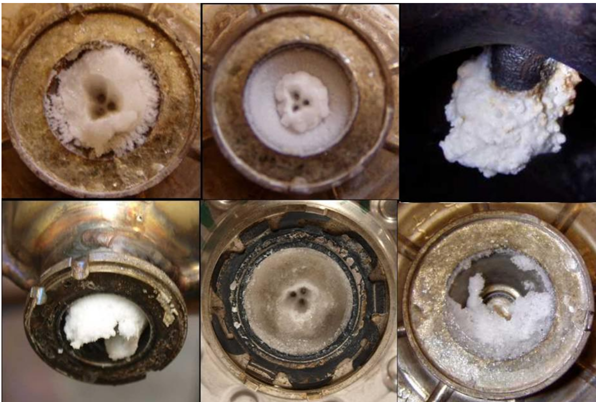
Abbildung 6.36: Beispiele für Ablagerungen an der Düsen Spitze und am Düsensitz
