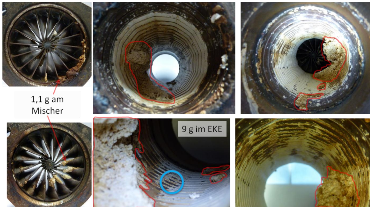
Abbildung 6.77: Ablagerungen (rot gerahmt) in einem EKE mit Hydrolyse-Beschichtung.
