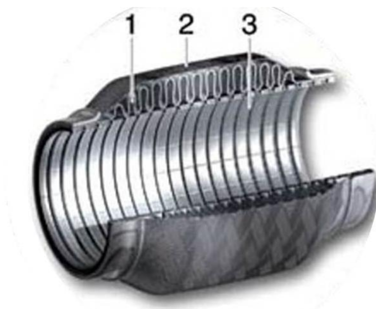
Abbildung 5.17: Aufbau eines Entkoppelementes im Abgasstrang [115]
