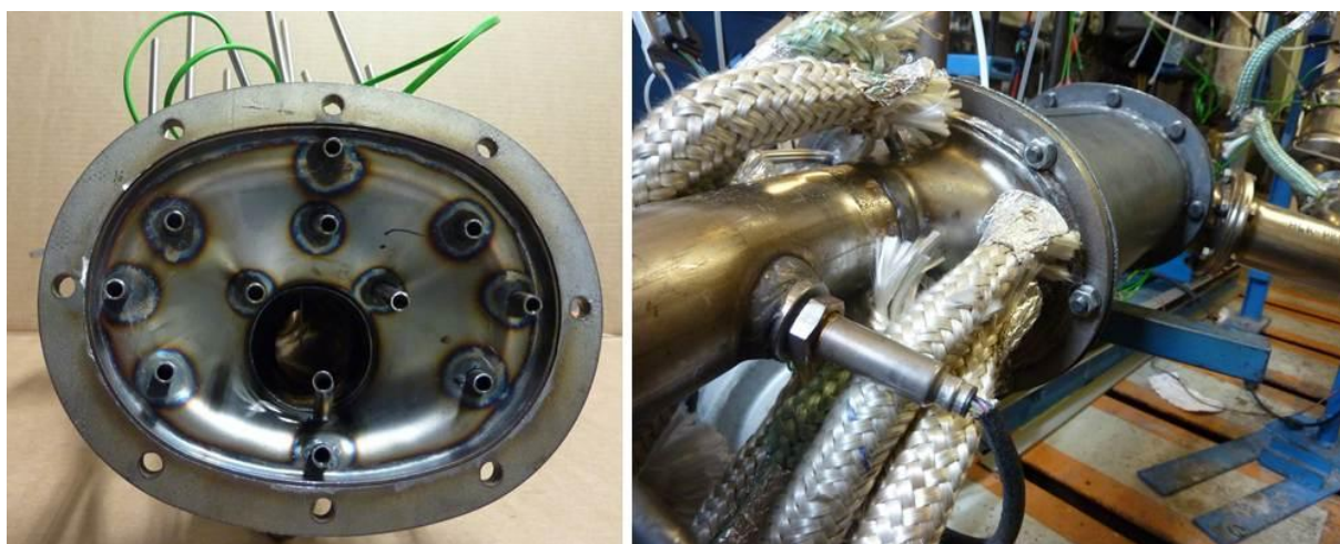
Abbildung 5.4: Geschlossenes System - verschraubter Auslasstrichter mit 12 Messstellen und NO x -Sonde im Endrohr.
