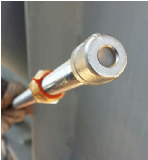
Abbildung 45: Messsonde mit Blick auf den Filter
