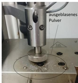
Abbildung 3.12 PE Pulver wird beim Stempelvorgang ausgeblasen
