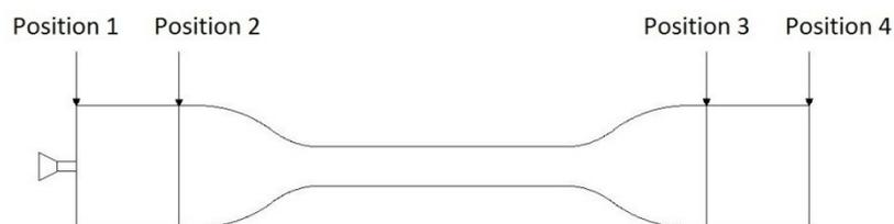
Abbildung 5.1 Probenentnahmestellen für 0,13 wt% Irganox 1010
