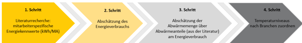
Abbildung 5-8: Schritte zur Abschätzung des Abwärmepotenzials, eigene Darstellung
