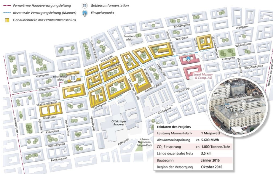
Abbildung 2-20: Einspeisung von Manner ins Fernwärmenetz [Wien Energie, 2016b: online]
