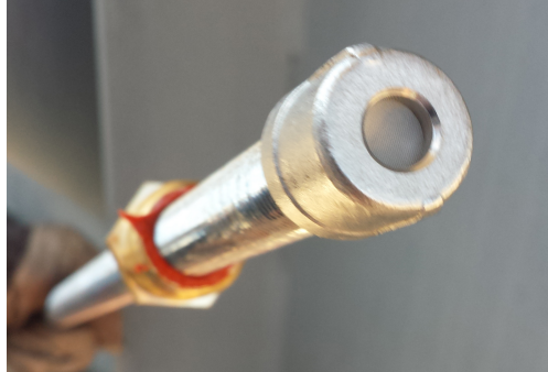
Abbildung 2.3: Vorderes Ende einer Druckmesssonde mit Drahtgewebe
