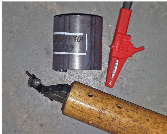
Abbildung 3.1: Kennzeichnung eines zugeschnittenen Rohres
