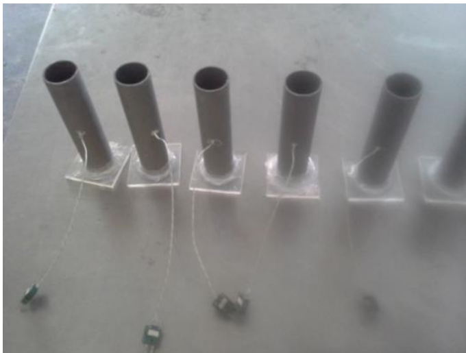
Abbildung 5.5-5: Die vorbereiteten Probekörper. In der Mitte der Probekörpern befinden sich die Löcher, in die die Thermodrähte eingesteckt werden
