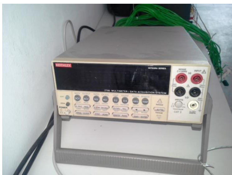
Abbildung 5-8: Digital-Multimeter Datenerfassung und Datenaufzeichnung ( Abk. DMM)
