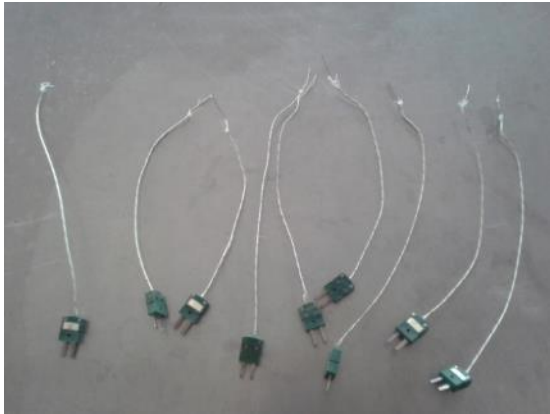
Abbildung 5.4-1: Thermodrähte. Sie werden als Verbindung zwischen Temperaturmessgerät und Probekörper gedient
