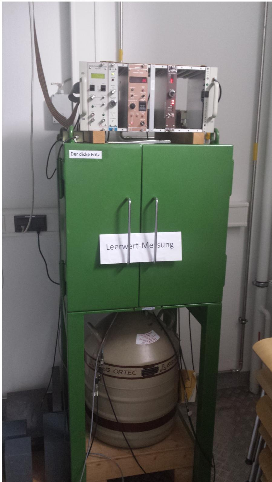
Abbildung 31: "Der dicke Fritz": der Detektor, der im Rahmen dieser Diplomarbeit verwendet wurde. "Der dicke Fritz" ist einer von zwei Detektor des Gamma-Spektroskopiesystems im Radiochemielabor des Atominstitutes.
