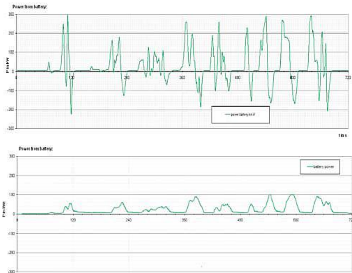
Abbildung 15 – Batterieleistung ohne (oben) und mit (unten) Ultracaps von Change it [23]
