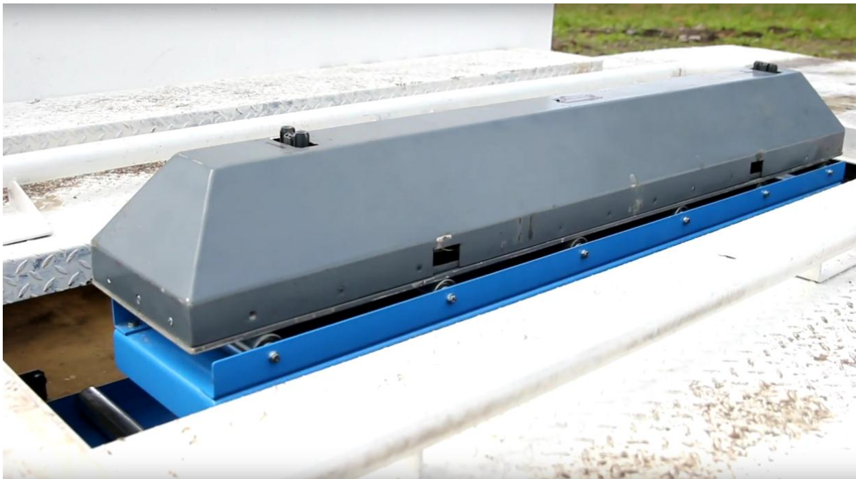
Abbildung 9 – Batteriepaket und Wechsellvorrichtung von BattSwap [21]
