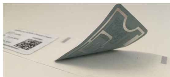
Abbildung 2-6: Smart Label, auch Smart Tag genannt.
