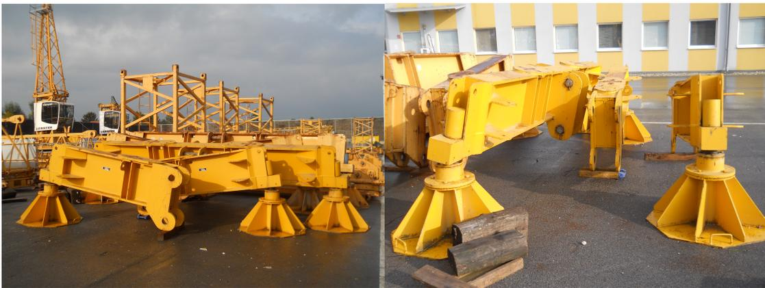
Abbildung 5.31: Elemente eines Fundamentkreuzes<sup>237</sup>
