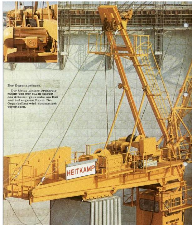
Abbildung 5.17: Gegenausleger eines Knickauslegerkrans<sup>199</sup>
