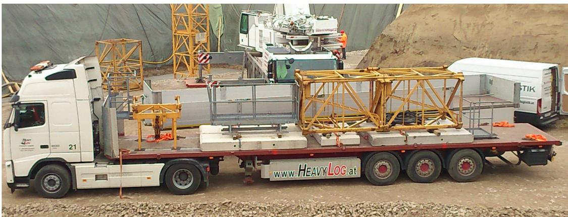
Abbildung 5.55: Transport von Kranteilen<sup>287</sup>
