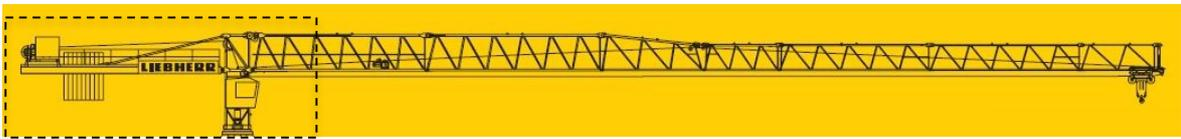
**Abbildung 5.11: Ausleger eines Liebherr Krans 180 EC-B<sup>187</sup>**
