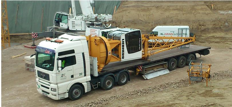
**Abbildung 5.57: Krantransport von vormontierten Kranelementen<sup>291</sup>**
