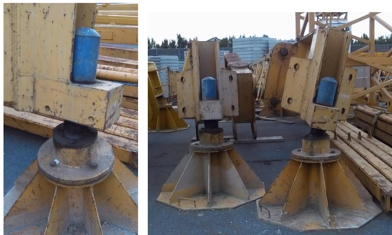
**Abbildung 5.33: Kugelgelagerte Spindeln<sup>239</sup>**
