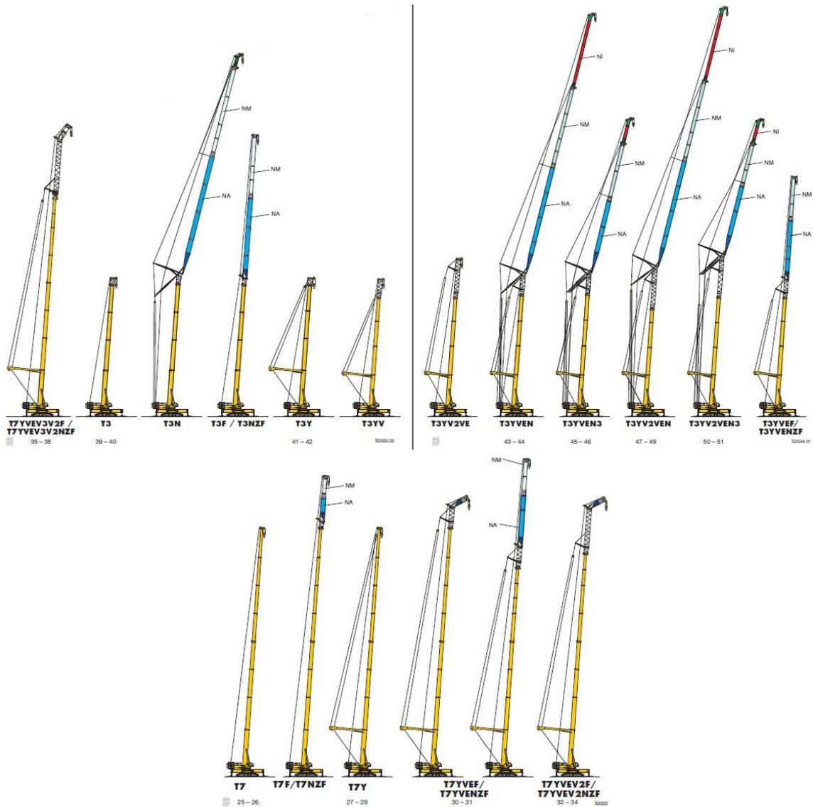
Abbildung 4.3: Auslegervarianten eines Teleskophauptausleger-Raupenkran<sup>96</sup>
