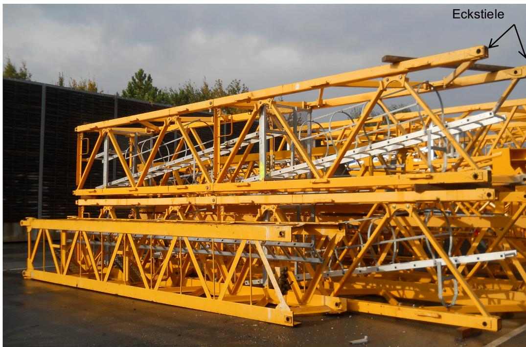
Abbildung 5.43: Turmstücken mit unterschiedlichen Leiterformen<sup>265</sup>
