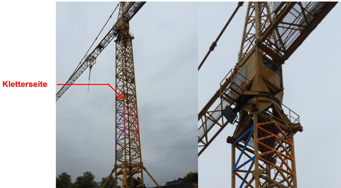
**Abbildung 5.50: Kletterturm: Zwei unterschiedliche Turmseiten**<sup>275</sup>
