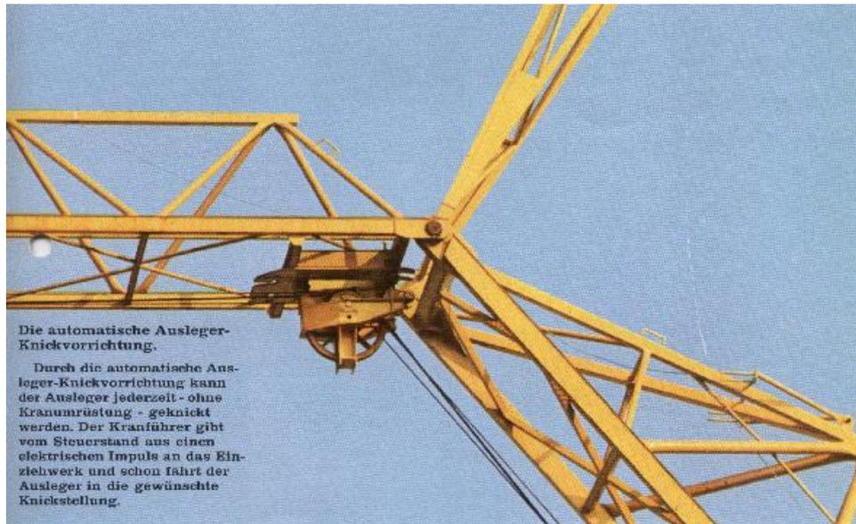
**Abbildung 5.16: Verbindung zwischen die zwei Auslegerteile einen Knickauslegerkran**<sup>195</sup>
