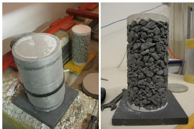
Abbildung 3.19: links: Mit Gips abgeglichene Oberseite der Probe in der zylindrischen Form, rechts: fertiger Probekörper
