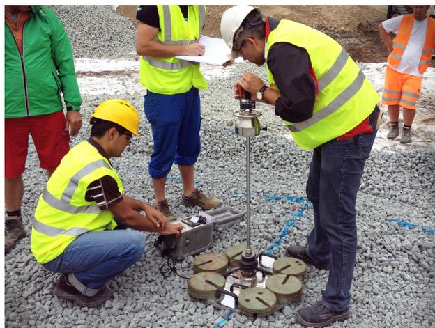
Abbildung 4.8: Versuchsdurchführung mit Auflastring um die Lastplatte
