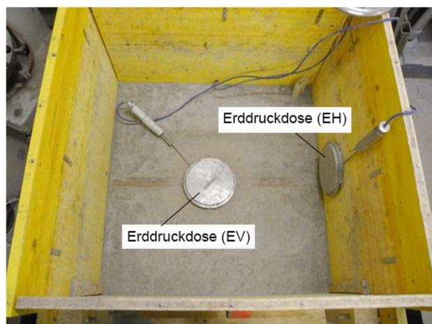
Abbildung 3.27: Versuchsbehälter mit situierten Erddruckdosen zur Durchführung von dynamischen Lastplattenversuchen
