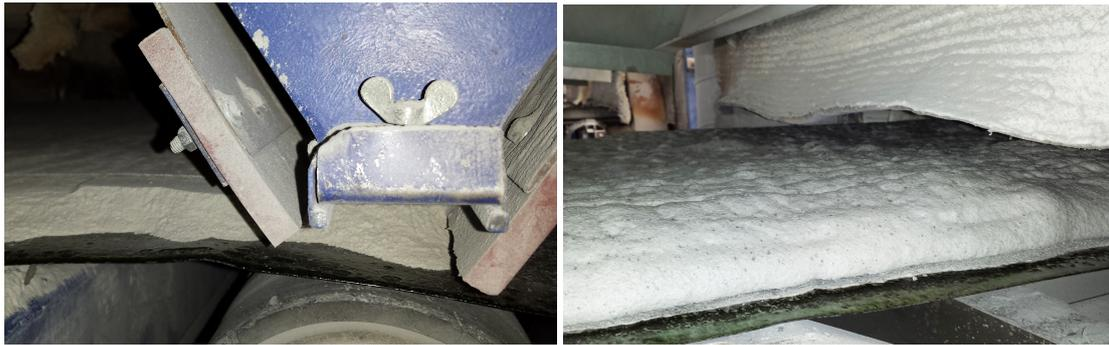
Abbildung 2.3: links: Glaspulver-Treibmittelgemisch auf Endlosband aus Edelstahl, rechts: fertiger „Kuchen“ [Fotos: TECHNOpor<sup>®</sup>]
