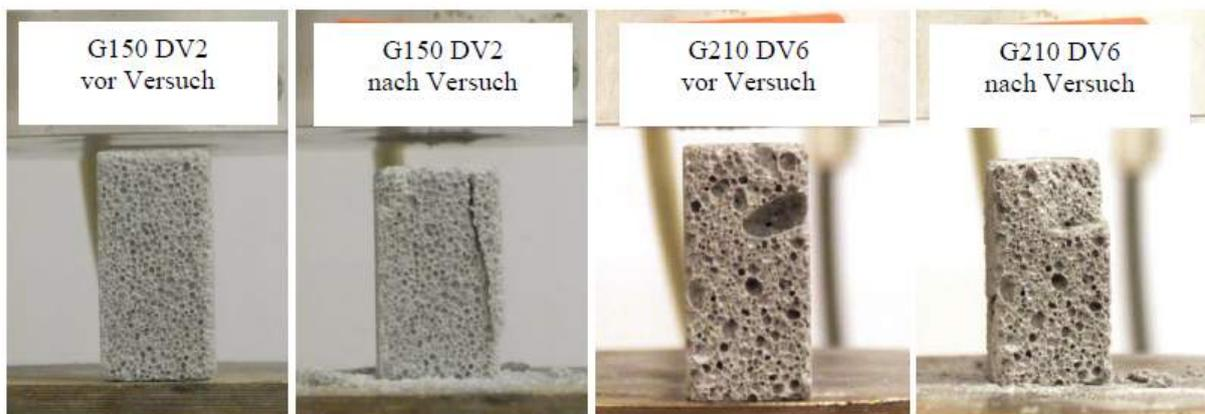
Abbildung 3.6: Probekörper vor und nach dem einaxialen Druckversuch (exemplarisch) [27]
