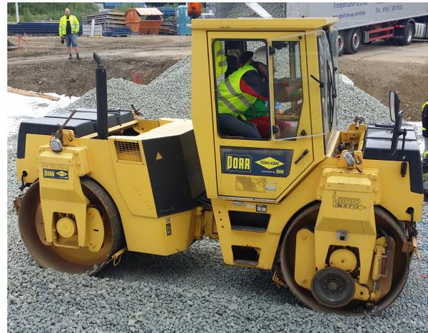
Abbildung 4.2: links: Tandemwalze Glattmantelbandagen Bomag BW 135 AD (3,6 t), rechts: Tandemwalze Glattmantelbandagen Bomag BW 151 AD-2 (7,6 t)
