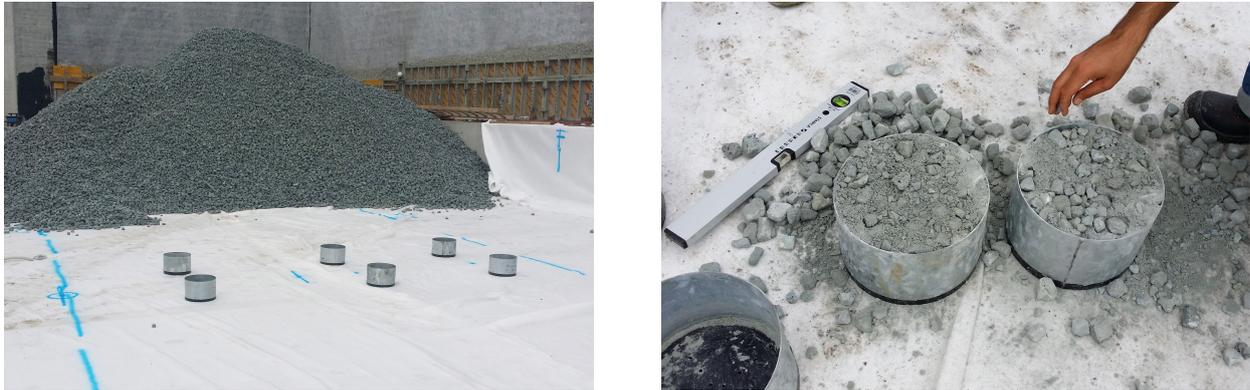
Abbildung 4.7: Volumenbestimmung mittels Zylindermethode
