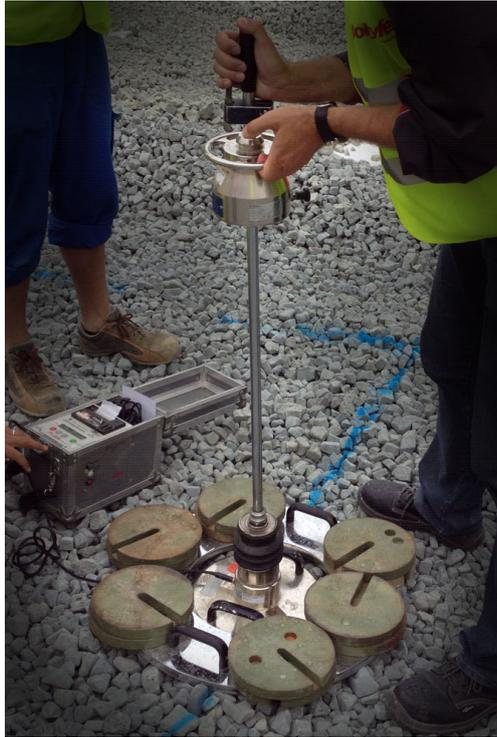
Abbildung 3.32: Versuchsaufbau mit Auflasting um die Lastplatte
