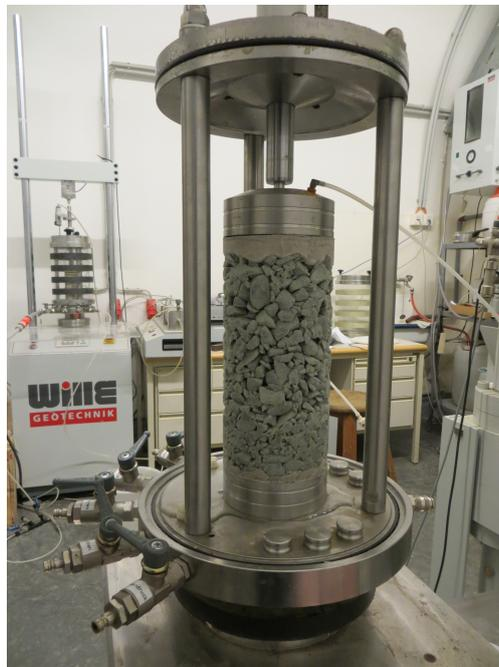
Abbildung 3.20: Probe in Triaxialzelle für einen einaxialen Druckversuch
