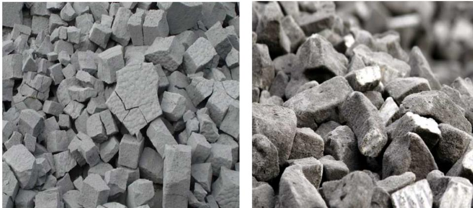
Abbildung 2.4: links: GSG hergestellt mit Trockenschäumverfahren, rechts: mit Nassschäumverfahren [28]
