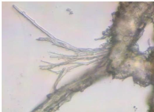
**Abb. 6.2:** Randbereich mit herausragenden Asbestfasern, aus LEYDOLPH [33]
