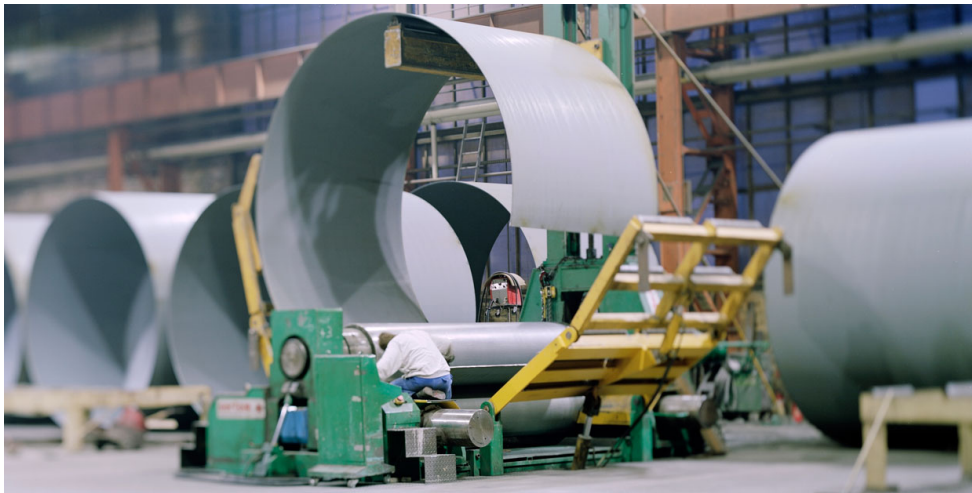
(a) Walzvorgang eines Segmentrohrs
