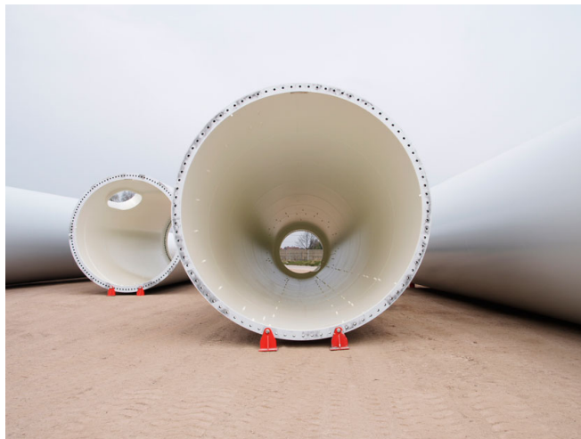
(b) Stahlrohrsegmente mit Flansch an beiden Enden
