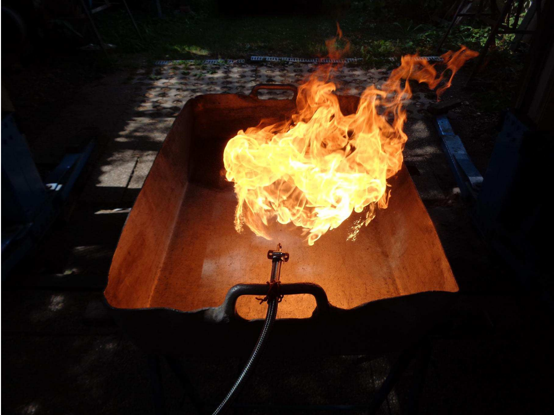
Abbildung 19: Spritzbild bei 3,0 bar Einspritzdruck
