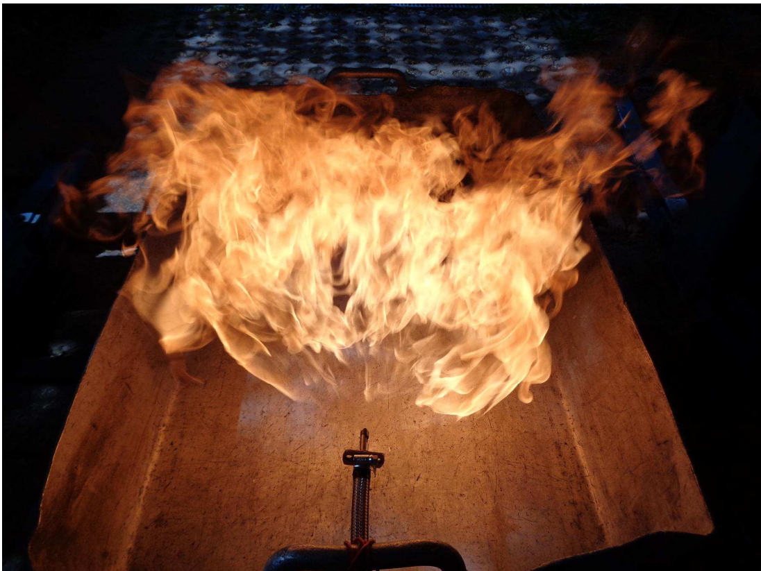
Abbildung 18: Spritzbild bei 6,9 bar Einspritzdruck
