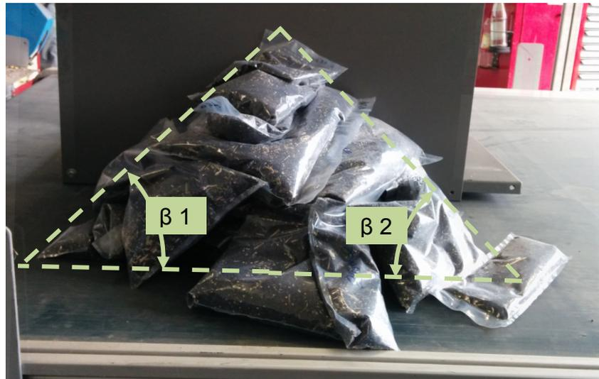
Abbildung 21: Ermittlung des Schüttwinkels
