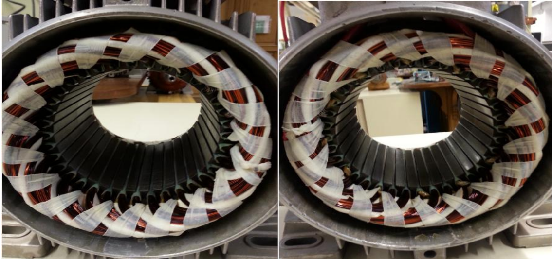
Abbildung 11.7: Seitenansicht der getränkten Wicklungen vor dem Alterung
