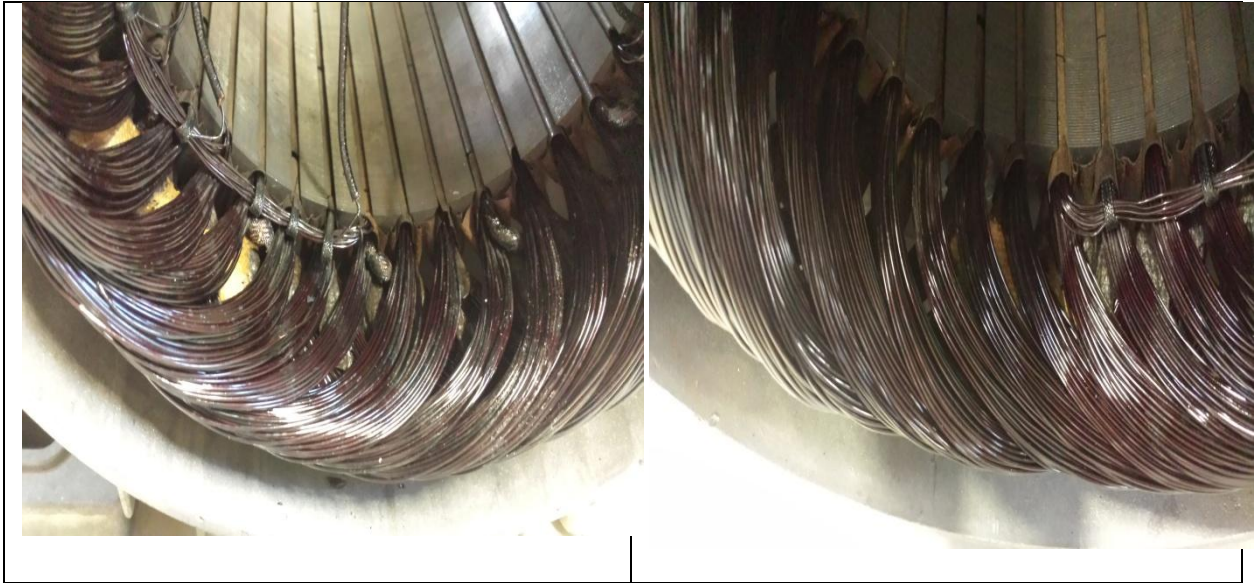
Abbildung 11.5: Seitenansicht der nicht getränkten Wicklungen bei 29. Vorgang
