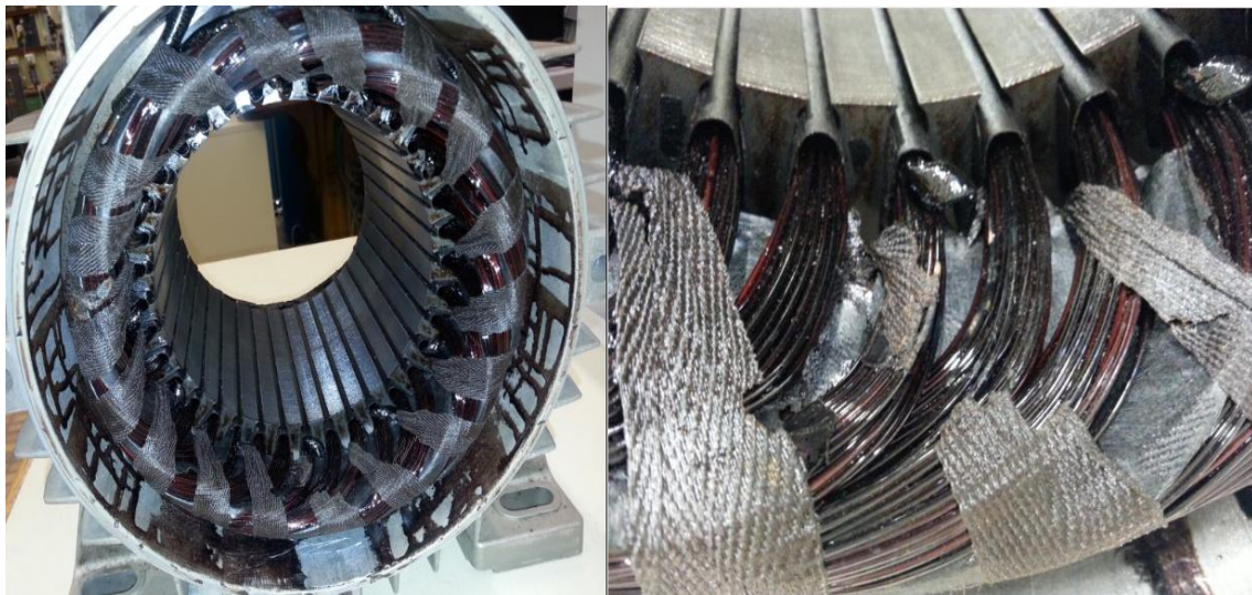
Abbildung 11.8: Seitenansicht der getränkten Wicklungen nach dem gealterten Wicklungen
