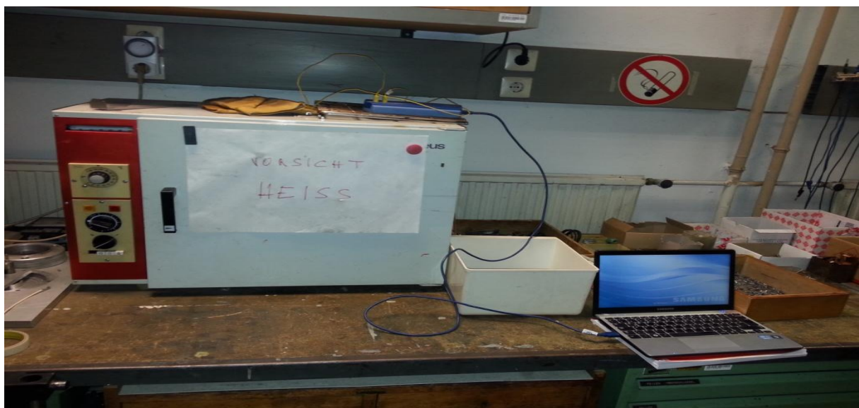
Abbildung 11.2: Abbildung von verwendeten Ofen und Zwischenstecker zum Heizprozess der Wicklungen
