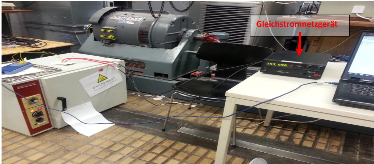
Abbildung 11.3: Abbildung von Einspeisung der zusätzliche Bestromung der Wicklungen
