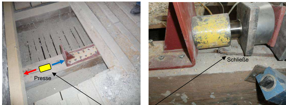
Abb. 70 und 71: freigelegte Schließe und Versuchsanordnung [15]
