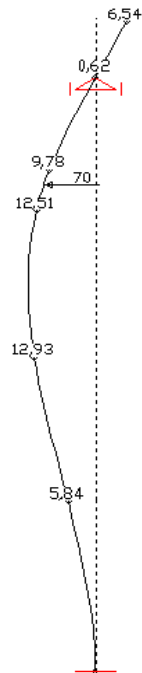
Abb. 101: Verformung des Pfeilers ohne Schließen, im Firstbereich gehalten
