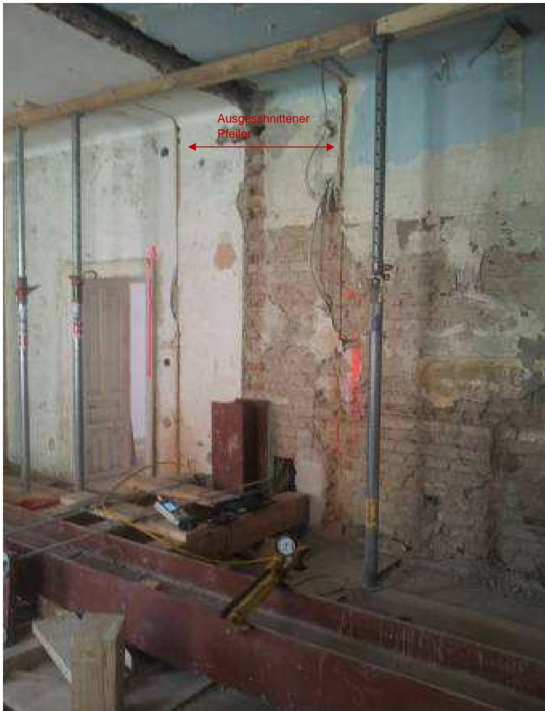
Abb. 94: Lasteinleitungsanordnung in Versuchswand [15]
