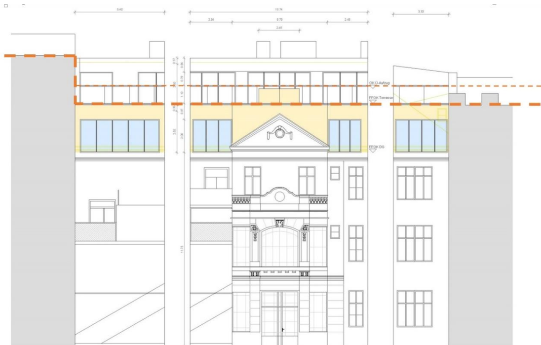
Abbildung 8- Hofansicht mit Ausnahme, d.h. mit einer beruhigteren Fassade
