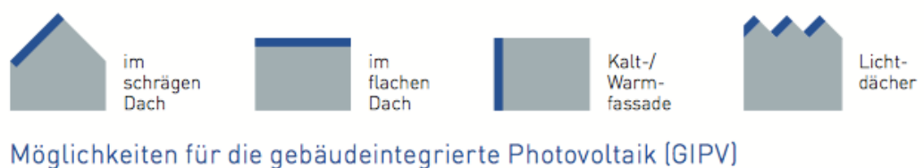
Abb. 9: Konstruktive Integration der photovoltaischen Zellen in die Gebäudehülle, Quelle: Photovoltaikfibel 2015
