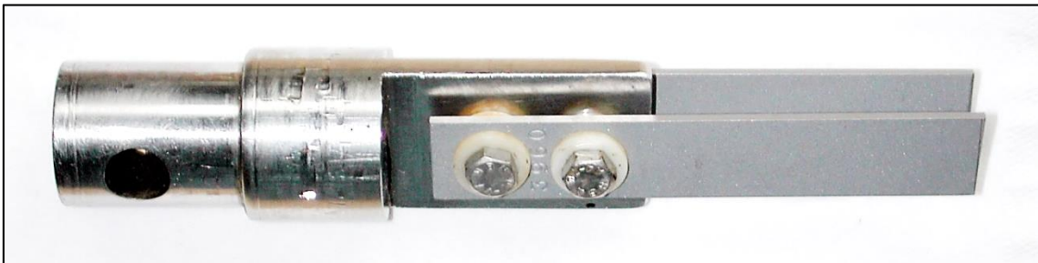
Abbildung 16: Halterung und eingespannte Korrosionskupons
