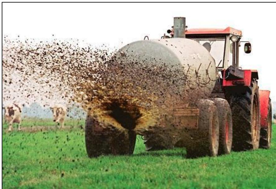
Abbildung 10: Ausbringung mittels Breitverteiler[25]
