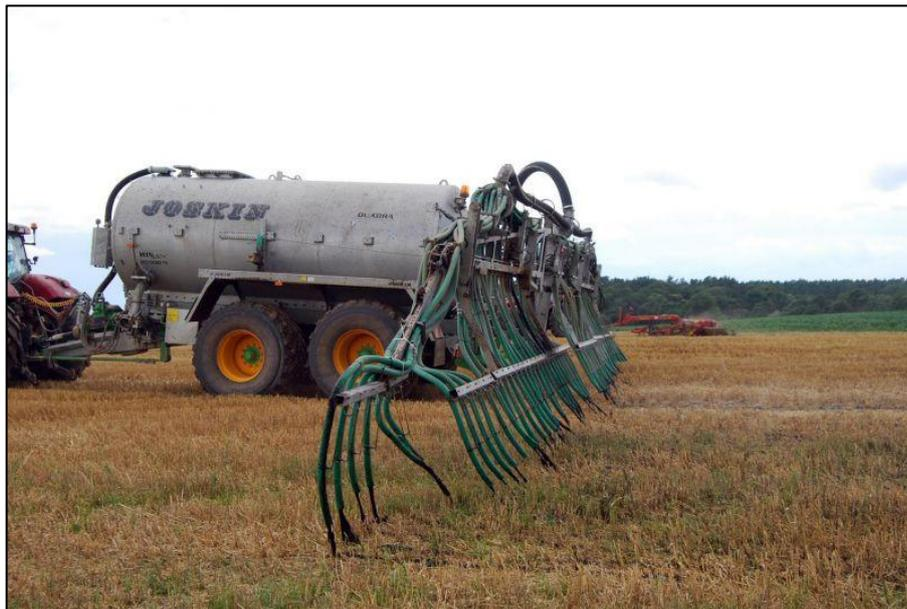
*Abbildung 11: Ausbringung mittels Schleppschlauchtechnik [27]*
