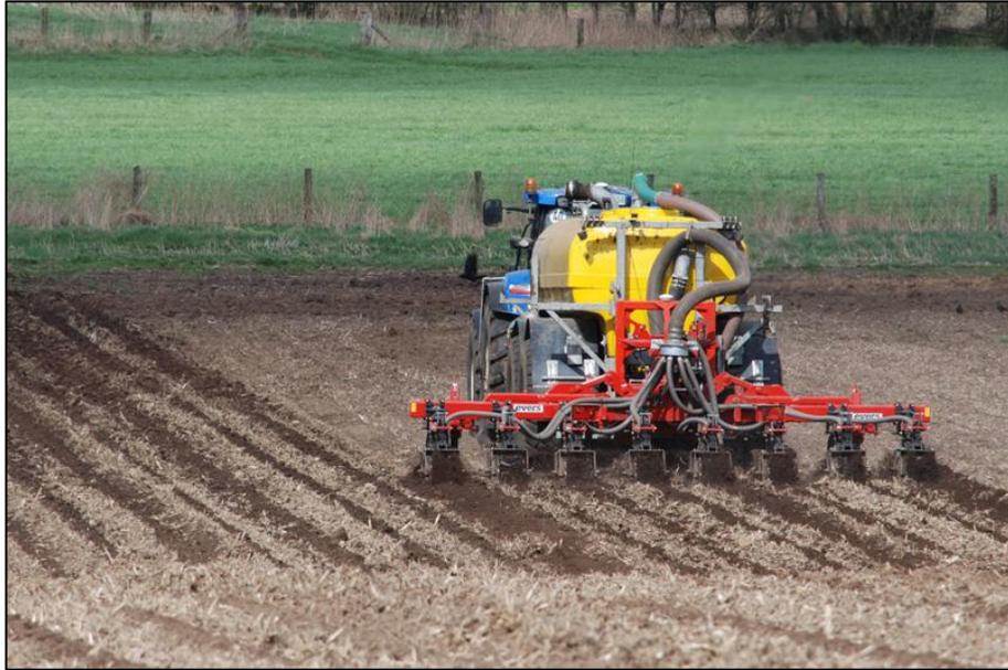
Abbildung 14: Ausbringung flüssiger Gärreste mittels Injektionsverfahren [26]
