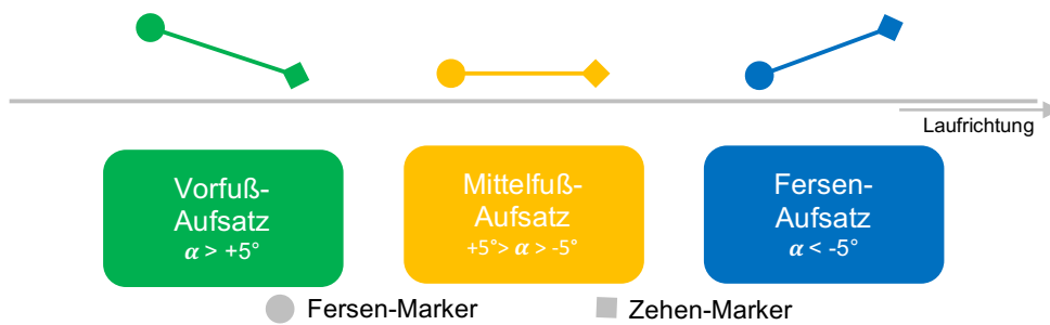
Abbildung 18: Stellung von Fersen- und Zehen-Marker beim IC bei unterschiedlichen Laufstilen
