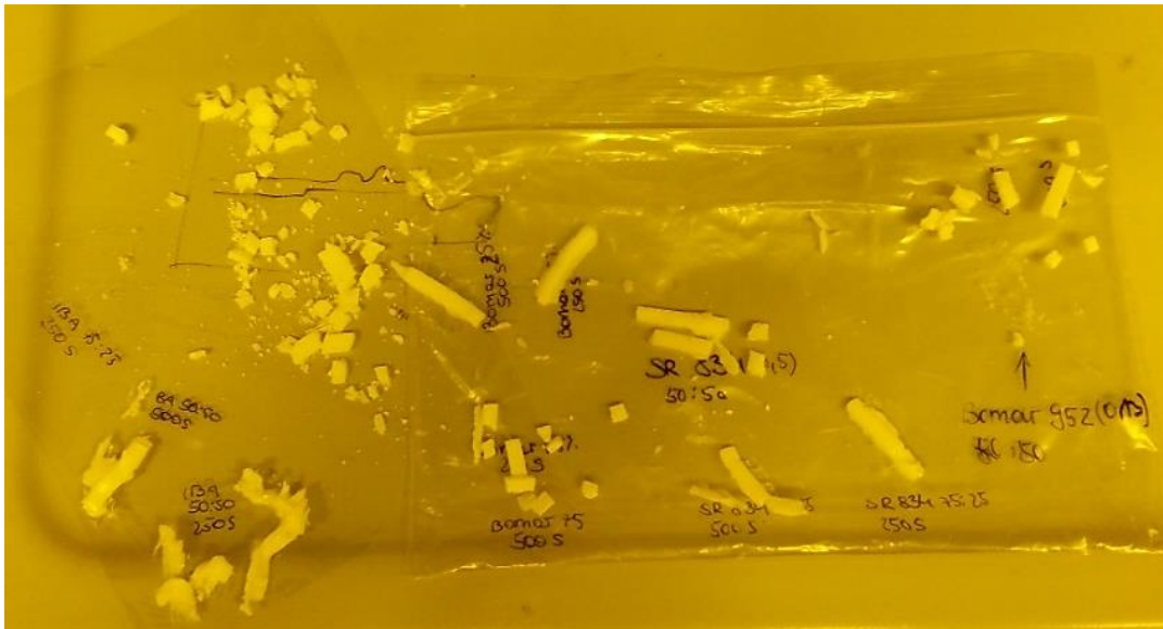
Abbildung 61: Härtingsergebnisse des Hybridsystems Acrylat mit Silikon
