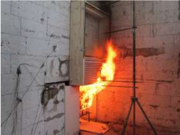
Abb. 5.60: Schmelzen der Aluminiumlamellen (4. Minute) [Foto des Autors]
