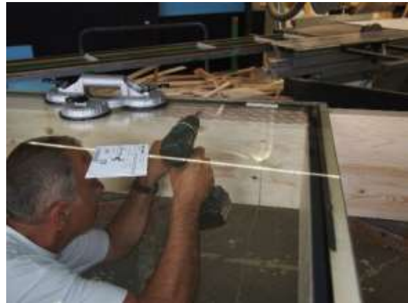
Abb. 5.43: Verschrauben des HGV-Elements [Foto des Autors]
