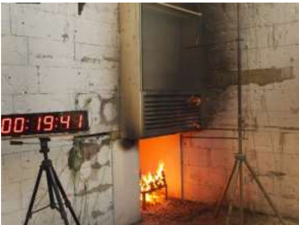
Abb. 5.102: V3 – Holzkrippe bricht zusammen [Foto des Autors]
