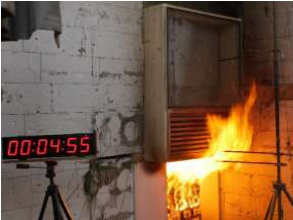
Abb. 5.100: V3 – Fassadenzwischenraum ohne Branderscheinungen [Foto des Autors]
