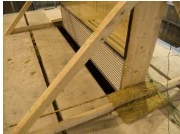
Abb. 5.160: Prüffassade über der Deckenöffnung [Foto des Autors]
