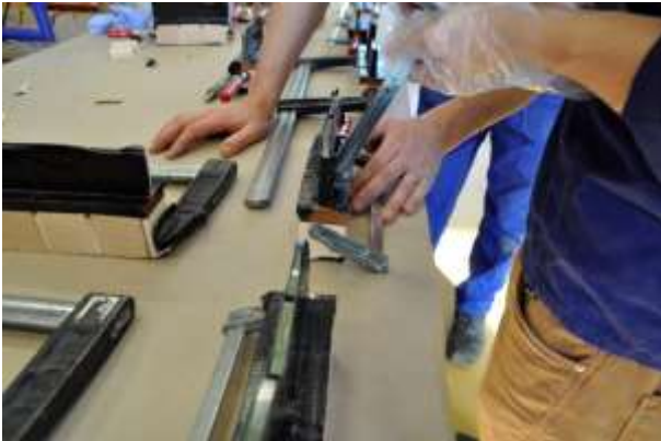
Abb. 5.9: Herstellen der Verklebung [Foto des Autors]
