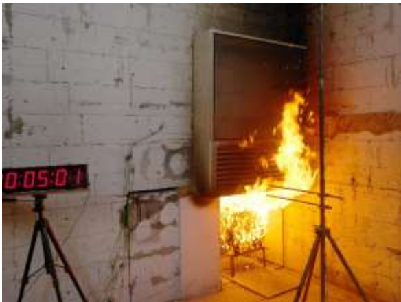
Abb. 5.92: V2 – Rotationswirbel im Lamellenbereich [Foto des Autors]
