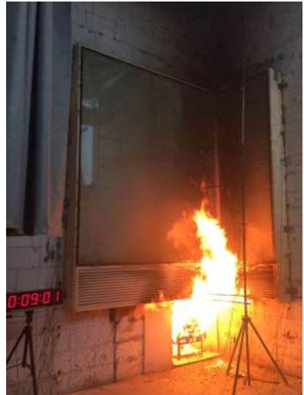
Abb. 5.141: Verlust des Raumabschlusses beim schmalen Fassadenelement [Foto des Autors]
