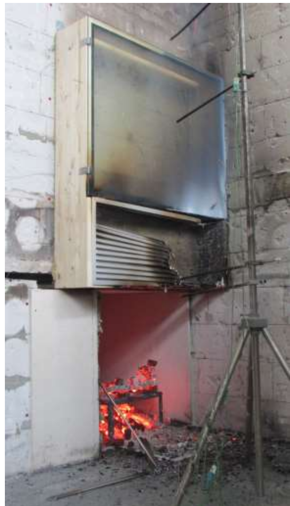
Abb. 5.63: Nach dem Zusammenbruch der Holzkrippe (23. Minute) [Foto des Autors]
