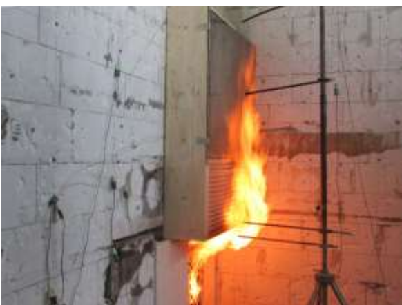
Abb. 5.54.:Flammenausbreitung entlang der Verglasung (4. Minute) [Foto des Autors]
