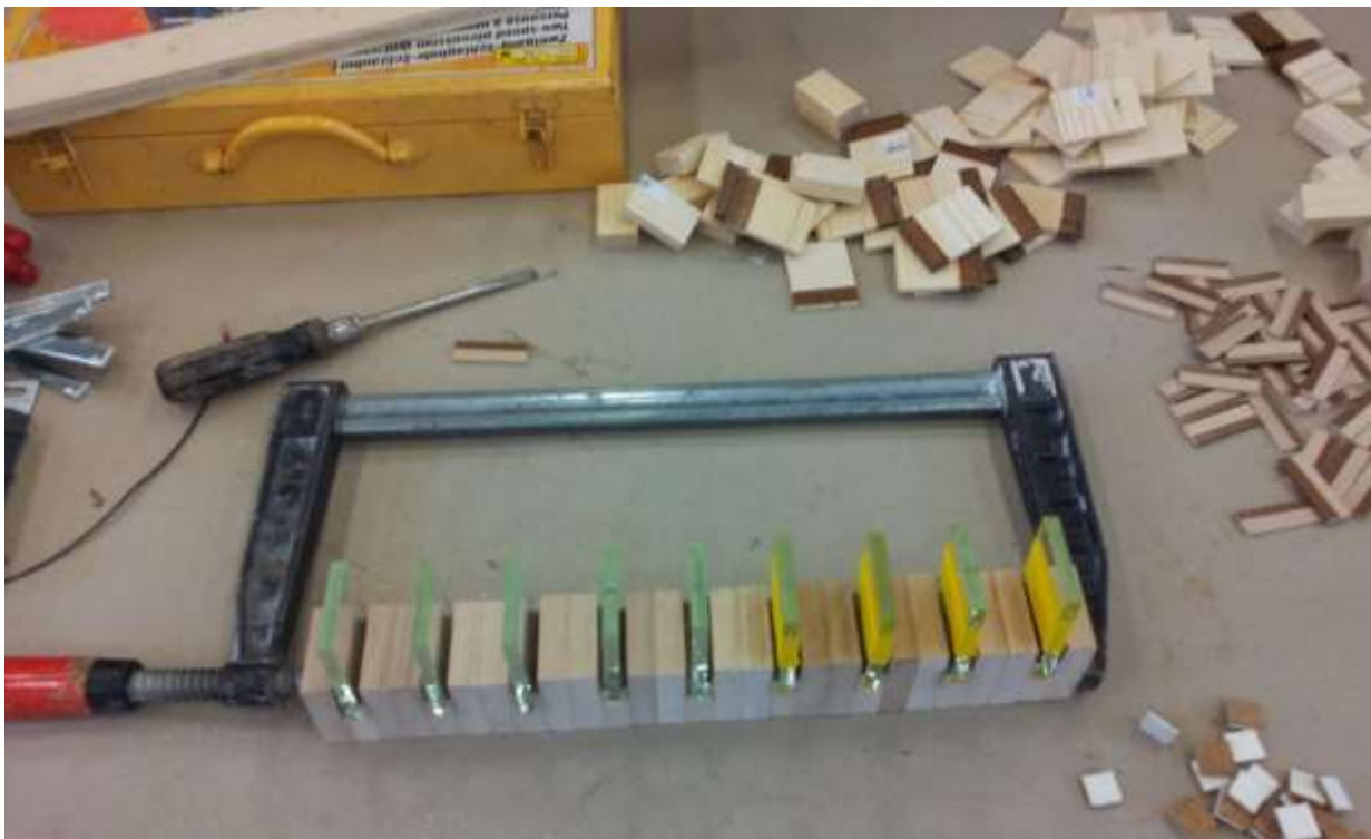
Abb. 5.8: Fertigung der Probekörper in der Werkstatt [Foto des Autors]
