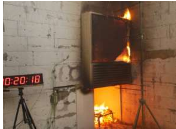
Abb. 5.97: V2 – Holzkrippe bricht zusammen [Foto des Autors]
