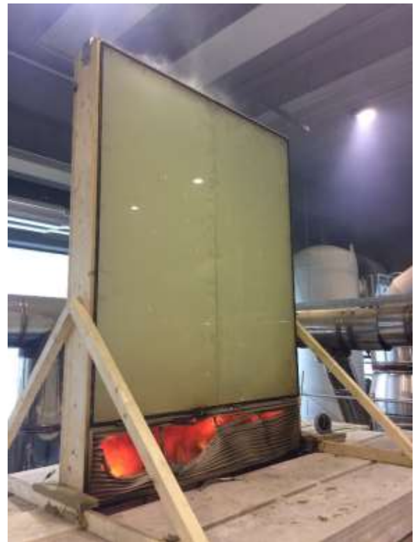
Abb. 5.164: Schmelzen der Aluminiumlamellen (2. Minute) [Foto des Autors]
