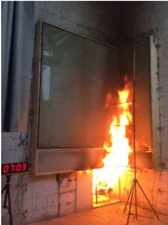
Abb. 5.140: Flammenausbreitung vor der Verglasung [Foto des Autors]
