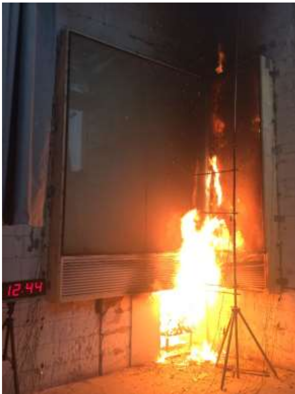
Abb. 5.142: Flammenaustritt an der Abluftöffnung des schmalen Fassadenelements [Foto des Autors]
