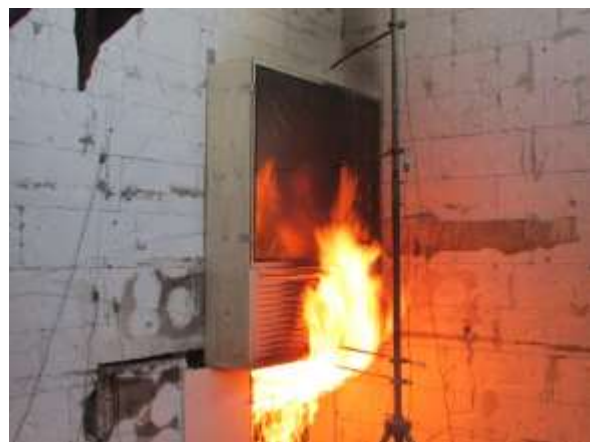
Abb. 5.55.:Spannungsrisse in der äußeren Glasscheibe (6. Minute) [Foto des Autors]
