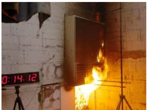
Abb. 5.95: V2 – Ethylvinylacetatfolie brennt entlang den Bruchkanten [Foto des Autors]
