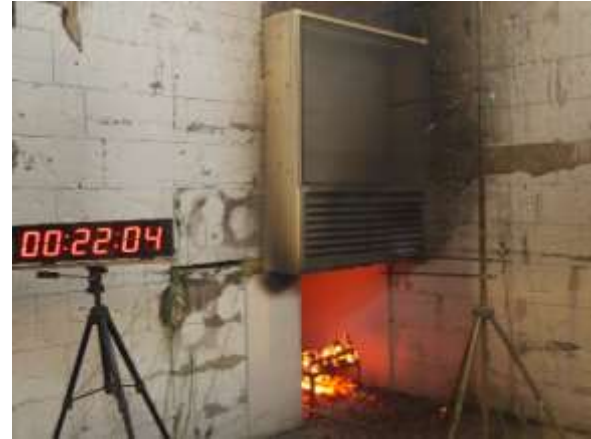
Abb. 5.103: V3 – keine sichtbaren Brandereignisse am Prüfobjekt [Foto des Autors]
