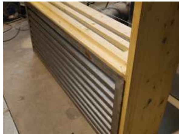
Abb. 5.91: V3 - Brandsperren und Stahllamellengitter [Foto des Autors]
