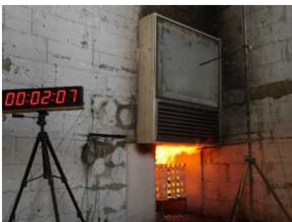
Abb. 5.98: V3 – Flammenausbreitung zum Zeitpunkt des Zuschaltens des Lüfters [Foto des Autors]
