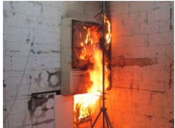
Abb. 5.57: Herabfallen der Verglasung (11. Minute) [Foto des Autors]
