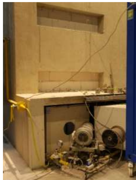
Abb. 5.51: Rückwand mit Brandkammeröffnung [Foto des Autors]
