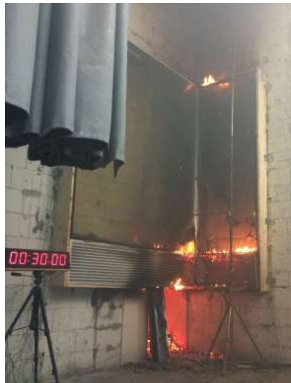
Abb. 5.145: Branderscheinungen zu Versuchsende [Foto des Autors]
