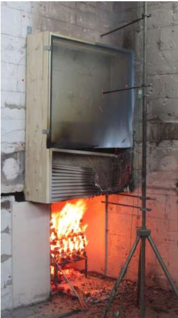
Abb. 5.62: verminderte Brandintensität (20. Minute) [Foto des Autors]
