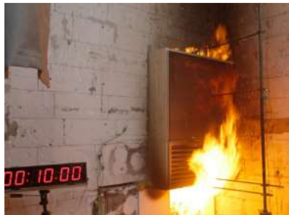
Abb. 5.93: V2 – Flammenaustritt bei Abluftöffnung [Foto des Autors]
