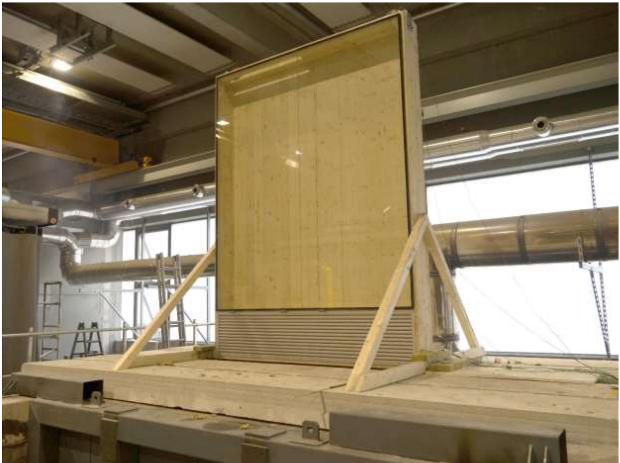
Abb. 5.156: Prüffassade P2 auf dem Deckenofen [Foto des Autors]
