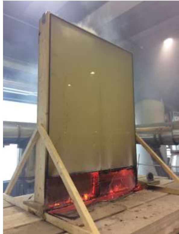
Abb. 5.166: Risse am linken Rand der Verglasung (22. Minute) [Foto des Autors]
