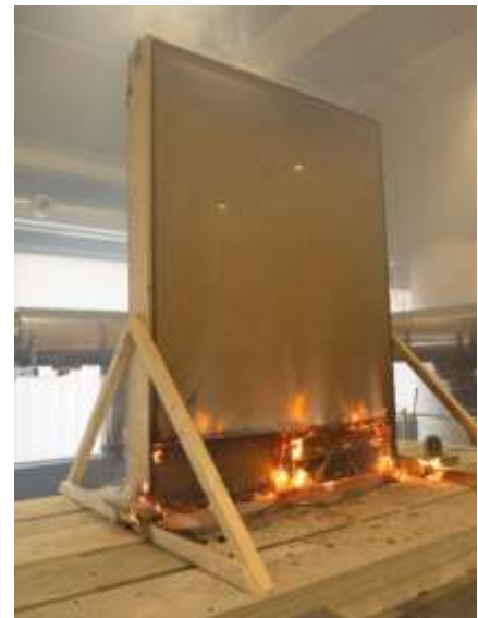
Abb. 5.169: Prüffassade nach Versuchsende [Foto des Autors]
