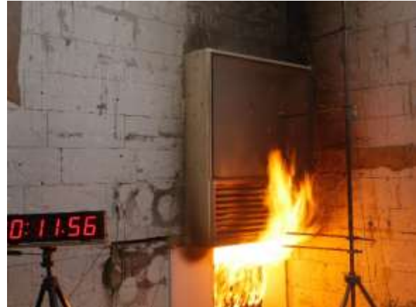
Abb. 5.101: V3 – Temperaturmaximum im Sturzbereich [Foto des Autors]
