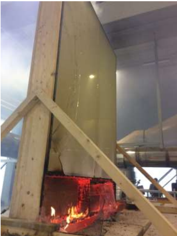
Abb. 5.167: Abfallen eines Glasstücks (24 Min. und 30 Sek.) [Foto des Autors]
