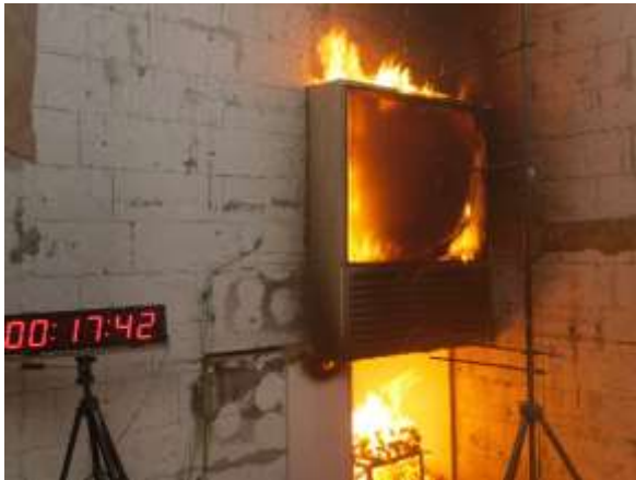
Abb. 5.96: V2 – Kamineffekt im linken Bereich des Fassadenzwischenraums [Foto des Autors]
