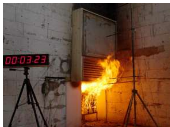
Abb. 5.99: V3 – Flammenausbreitung vor den Fassadenbereich [Foto des Autors]
