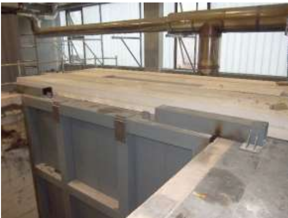
Abb. 5.159: Prüfofen mit Deckendielen und Öffnung [Foto des Autors]
