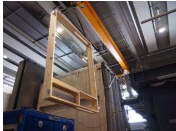
Abb. 5.134: Transport des Fassadenelements zum Prüfstand [Foto des Autors]
