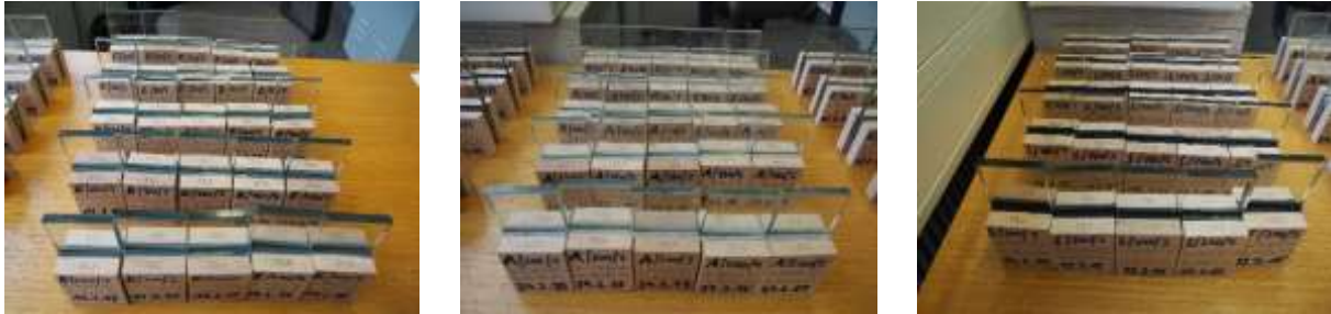
Abb. 5.5, 5.6, 5.7: (v.l.n.r.) Probeserie mit Epoxid-, Acrylat- und Silikonverklebung [Foto des Autors]
