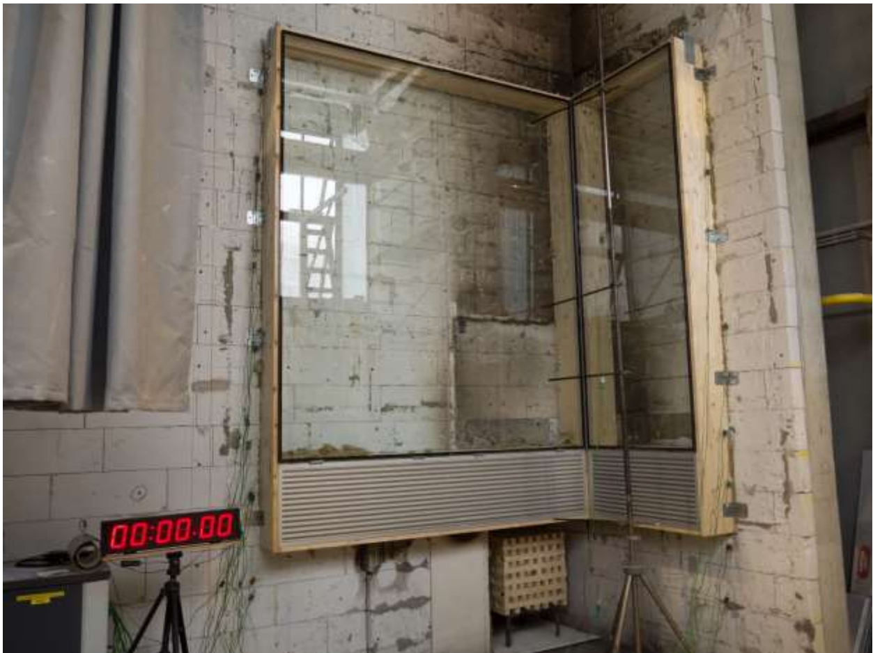
Abb. 5.125: Prüfanzordnung P1 am Fassadenprüfstand [Foto des Autors]
