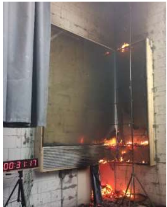
Abb. 5.146: Prüffassade vor dem Ablöschen [Foto des Autors]
