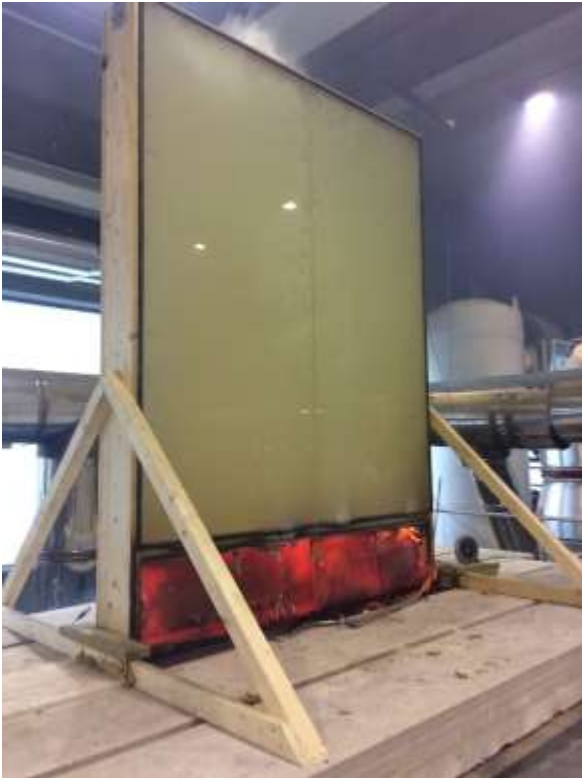
Abb. 5.165: Herabfallen der Aluminiumlamellen (5. Minute) [Foto des Autors]
