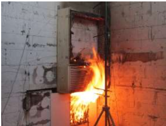
Abb. 5.58: verminderte Brandintensität (17. Minute) [Foto des Autors]
