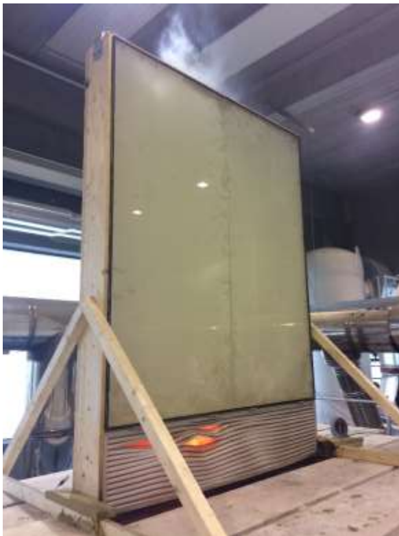
Abb. 5.163: Verformung der Aluminiumlamellen (1. Minute) [Foto des Autors]
