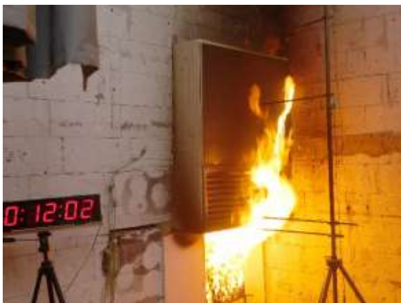
Abb. 5.94: V2 – Verlust des Raumabschlusses der Verglasung in der rechten unteren Ecke [Foto des Autors]
