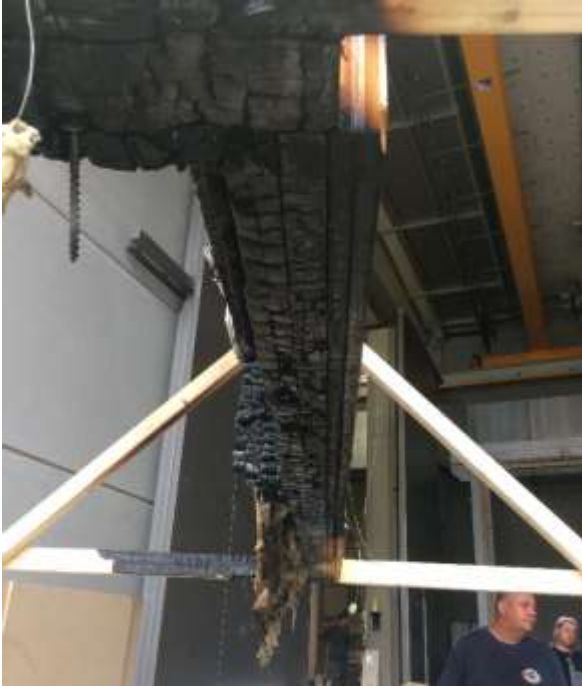
Abb. 5.170: Untersicht des Fassadenelements [Foto des Autors]
