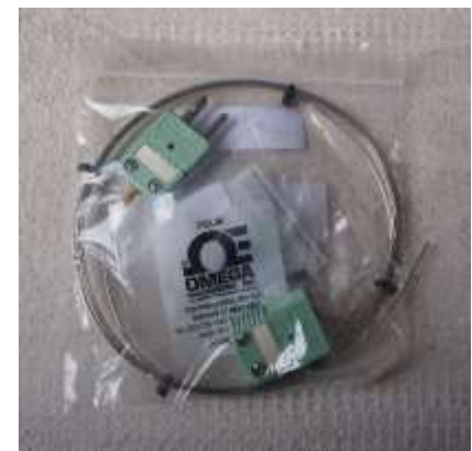
Abb. 5.52: Thermoelement Typ K [Foto des Autors]
