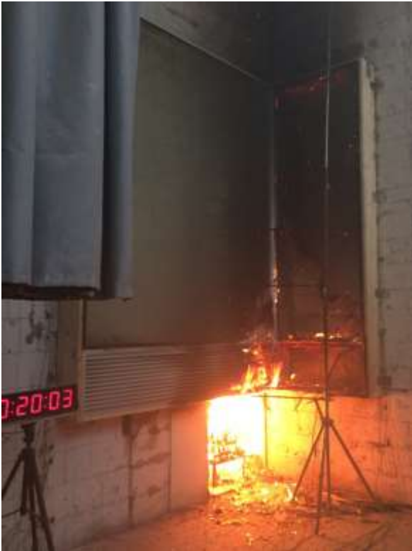
Abb. 5.144: Holzkrippe vor dem Zusammenfallen [Foto des Autors]
