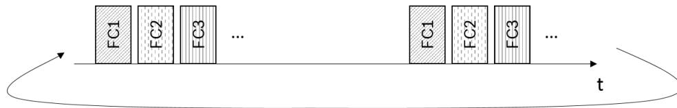
Abbildung 2.4: Zyklischer Aufruf der einzelnen Funktionen in einer festen Reihenfolge.
