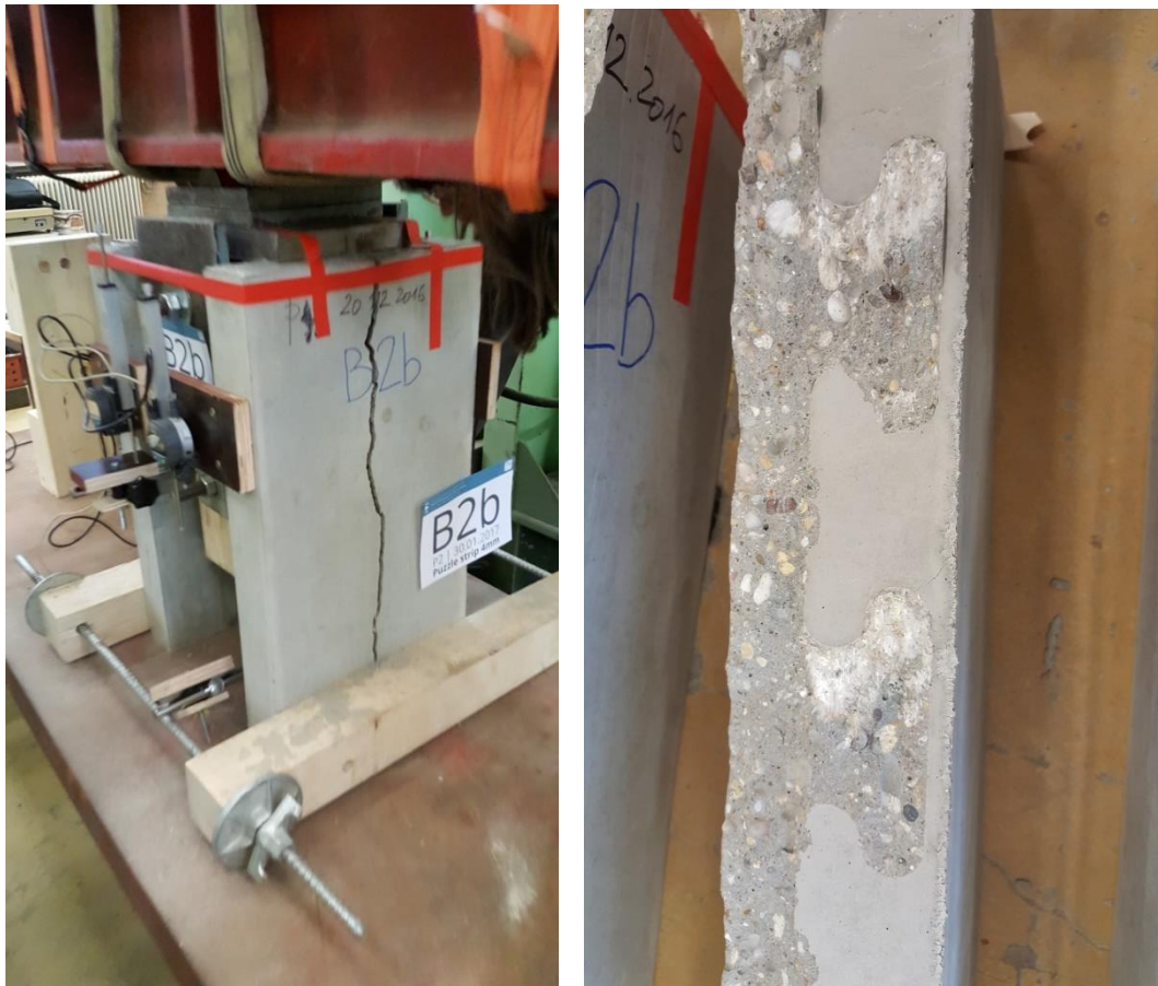
Abbildung 6-23: Probekörper B2b Puzzleleiste gerade, Versagen des Betons
