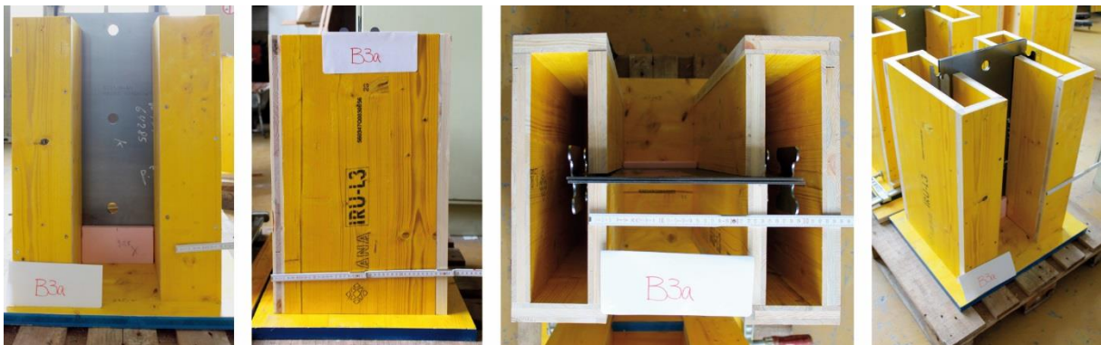
Abbildung 6-8: Schalungsaufbau B3a (Puzzleleiste abgekantet)
