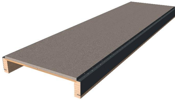
Abbildung 4-1: Visualisierung eines vorgefertigten hybriden Holz-Stahl-Beton-Rippendeckenelementes [47]
