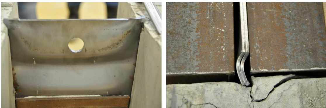
Abbildung 6-25: Probekörper B1b Puzzleleiste gerade, Versagen des Stahls (Beulen)
