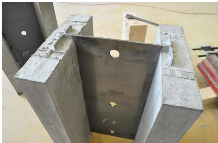
Abbildung 6-28: Probekörper B5b Lochleiste abgekantet, Versagen des Stahls (Beulen)
