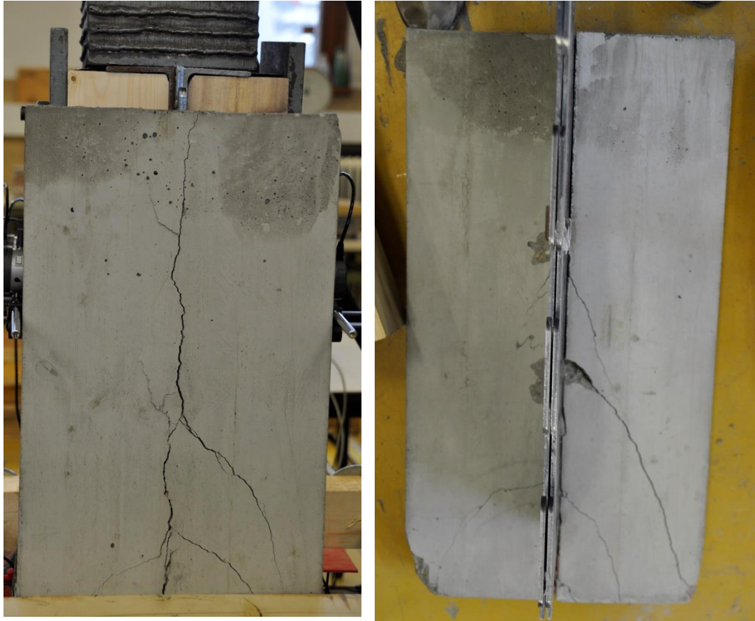
Abbildung 6-24: Probekörper B2a Puzzleleiste gerade, Versagen des Betons
