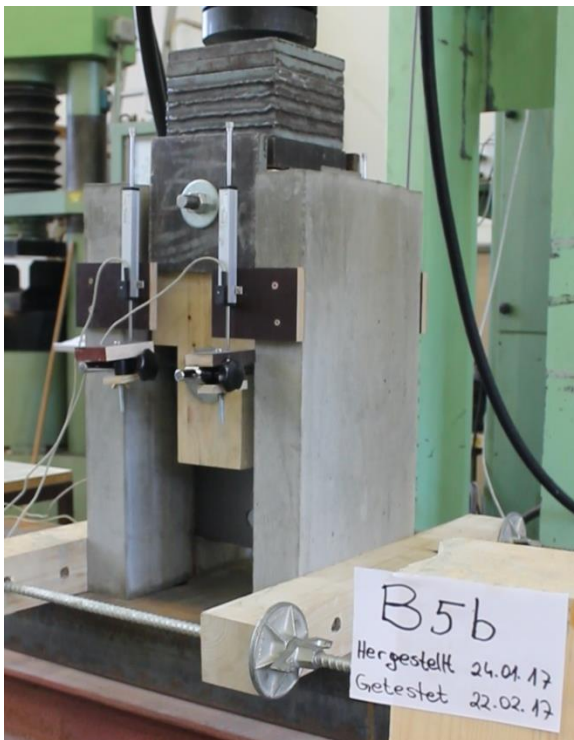
Abbildung 6-21: Überblick über die vierten Abscherversuche der Probekörper A1c, A1d, B5b und B6b
