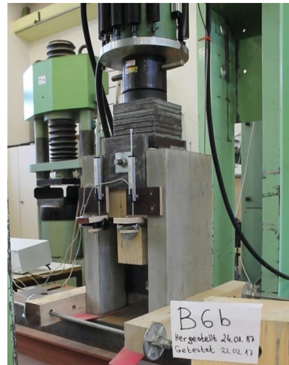
Abbildung 6-21: Überblick über die vierten Abscherversuche der Probekörper A1c, A1d, B5b und B6b
