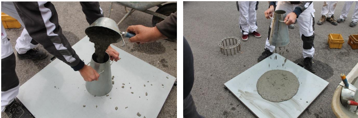
Abbildung 6-12: Ausbreitversuch erste Partie selbstverdichtender
