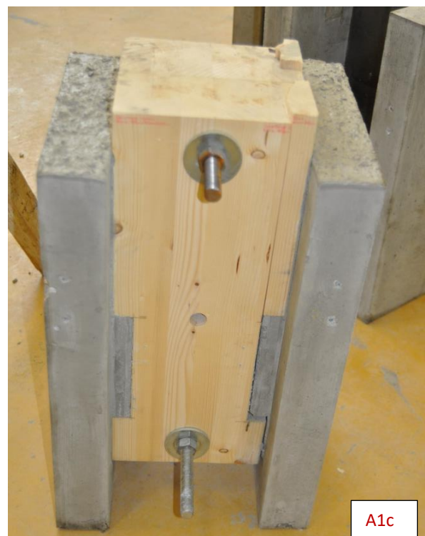
Abbildung 6-22: Holz-Beton-Verbundproben, Versagen; A1b (200/200/200 mm), A1d (300/200/100) und A1c (200/200/200 mm)
