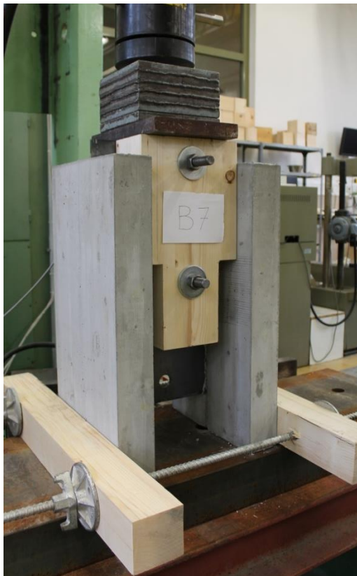
Abbildung 6-18: Überblick über die ersten Abscherversuche der Probekörper A1a, B1a, B7 und B3a
