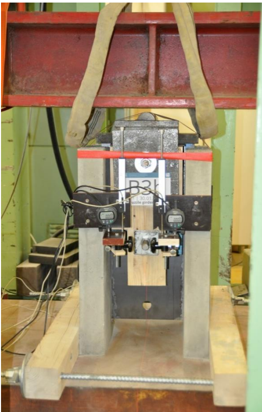
Abbildung 6-20: Überblick über die dritten Abscherversuche der Probekörper B1b, B2b, B3b und B4b
