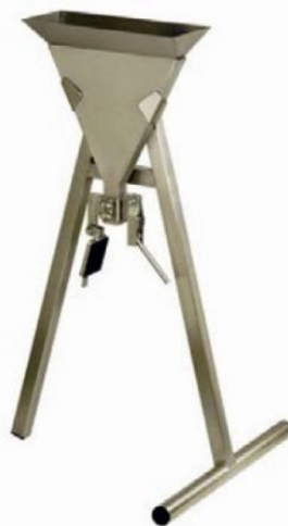
Abbildung 2-2: Auslauftrichter zur Bestimmung der Auslaufzeit [6]
