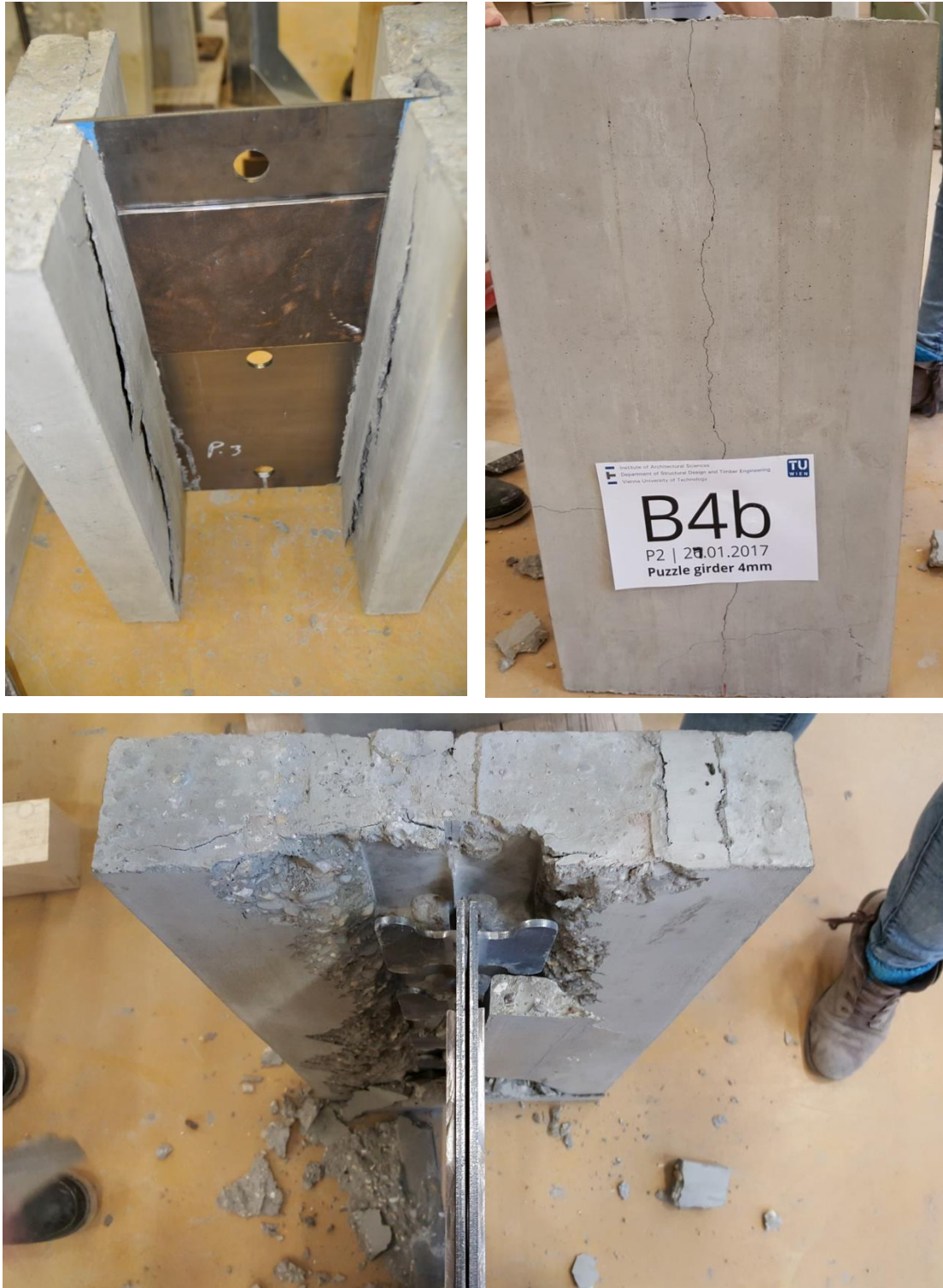
Abbildung 6-26: Probekörper B3b und B4b Puzzleleiste abgekantet, Versagen des Betons
