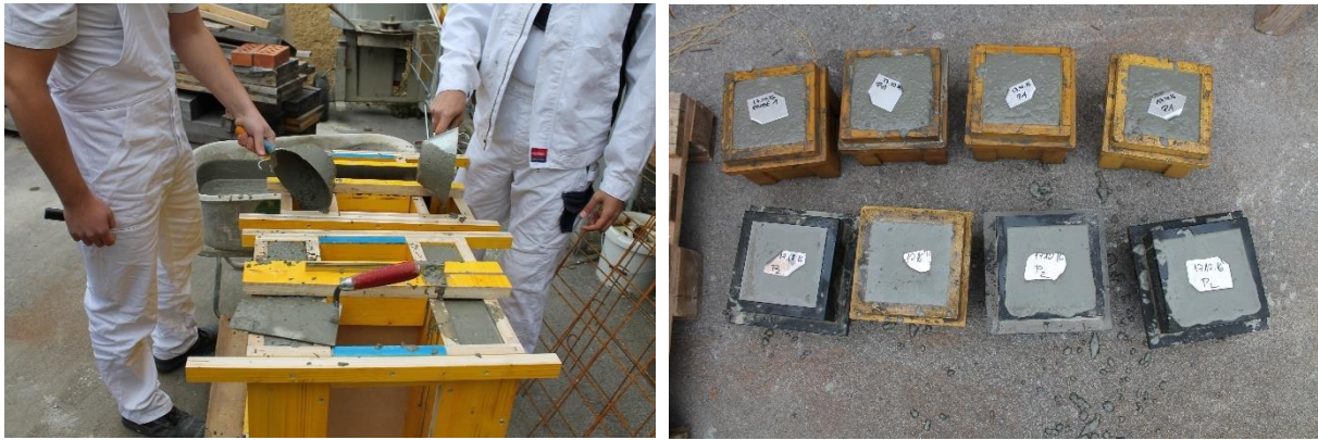
Abbildung 6-11: Betonieren der Probekörper und der Probewürfel
