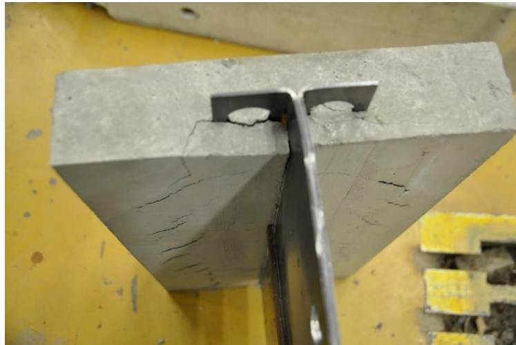
Abbildung 6-27: Probekörper B5a Lochleiste abgekantet, Versagen des Betons (Risse)
