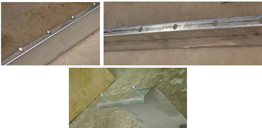
Abbildung 4-10: Schubverbindungsmechanismen; oben links: aufgebogene Laschen, oben rechts: vorgebohrte Löcher, unten: selbstschneidende Schrauben [58]
