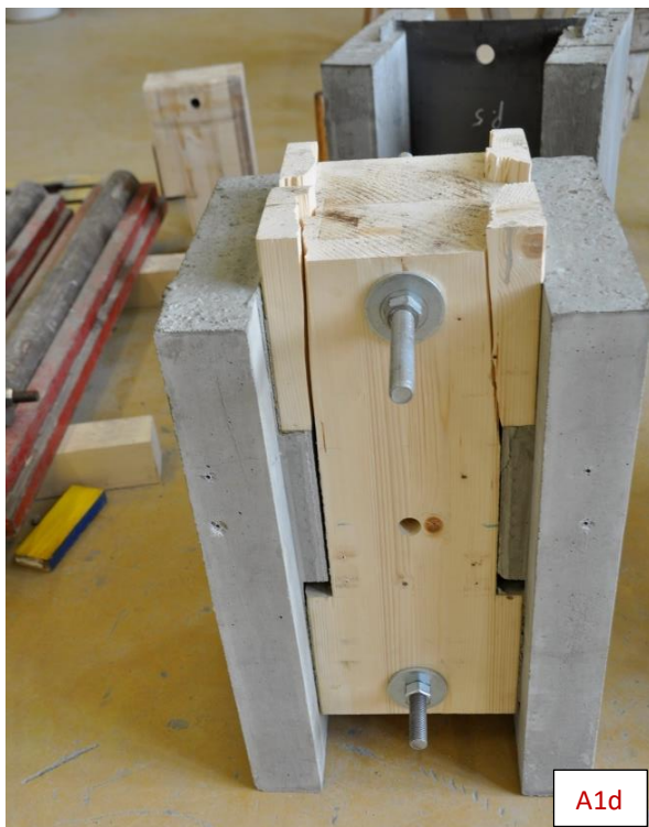
Abbildung 6-22: Holz-Beton-Verbundproben, Versagen; A1b (200/200/200 mm), A1d (300/200/100) und A1c (200/200/200 mm)
