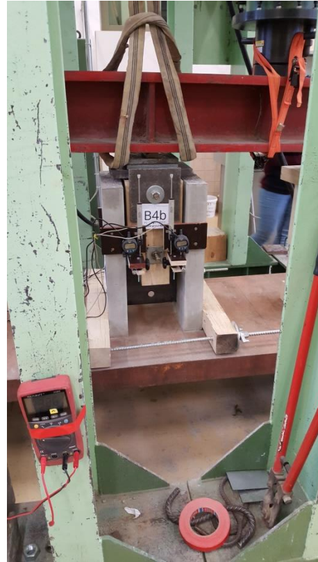
Abbildung 6-20: Überblick über die dritten Abscherversuche der Probekörper B1b, B2b, B3b und B4b
