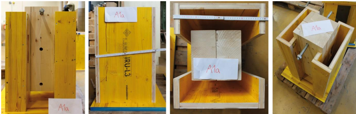
Abbildung 6-7: Schalungsaufbau A1a (Holzkerven)
