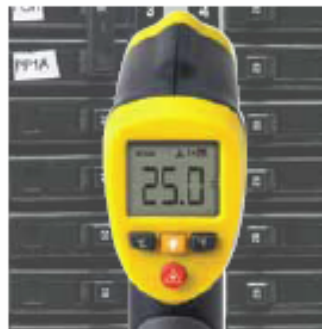
IR-Thermometer, Temperaturmessung an einem Punkt
