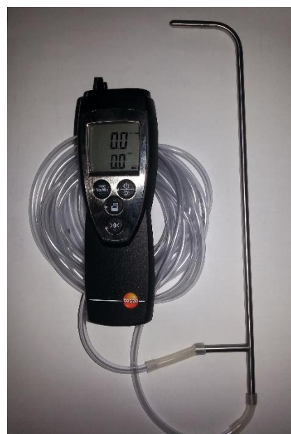
Abbildung 37: Differenzdruckmessgerät testo 512 mit Staudrucksonde rechts
