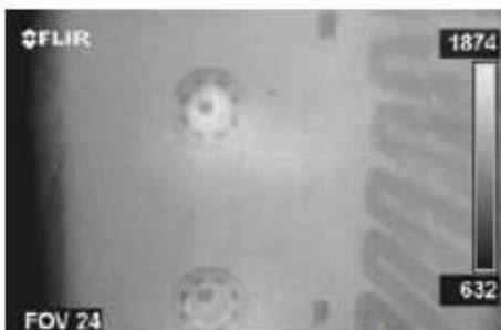
Wärmebild: dank des eingebauten Filters für Flammen kann die FLIR GF309 Wärmebildkamera durch Flammen hindurch sehen und sogar Temperaturen dahinter messen.
