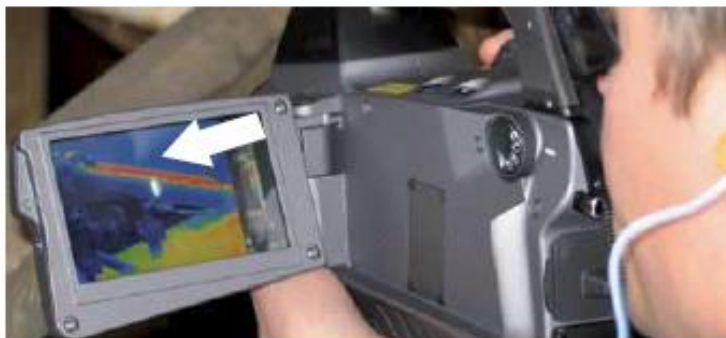
Echtzeitbild eines Gaslecks, das auf dem eingebauten LCD-Bildschirm angezeigt wird
