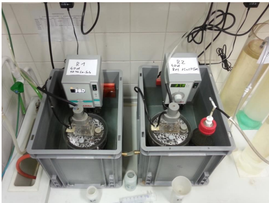
Abbildung 69: Labormaßstäbliche Reaktoren R1 und R2 im thermostatisierten Wasserbad (Tauber et al., 2016)
