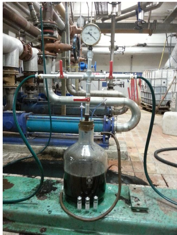
Abbildung 64: Vakuumapparatur befüllt mit Faulschlamm, 10 ml Gasproben im Vordergrund
