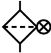
Abbildung 53: Symbolische Darstellung eines Filters mit Verschmutzungsanzeige
