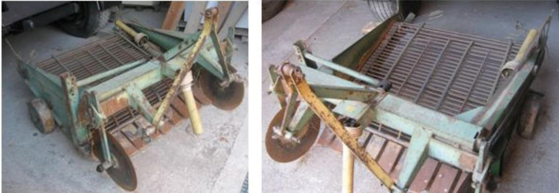
Abbildung 26: Schwingsiebroder Fabrikat "Kuxmann"
