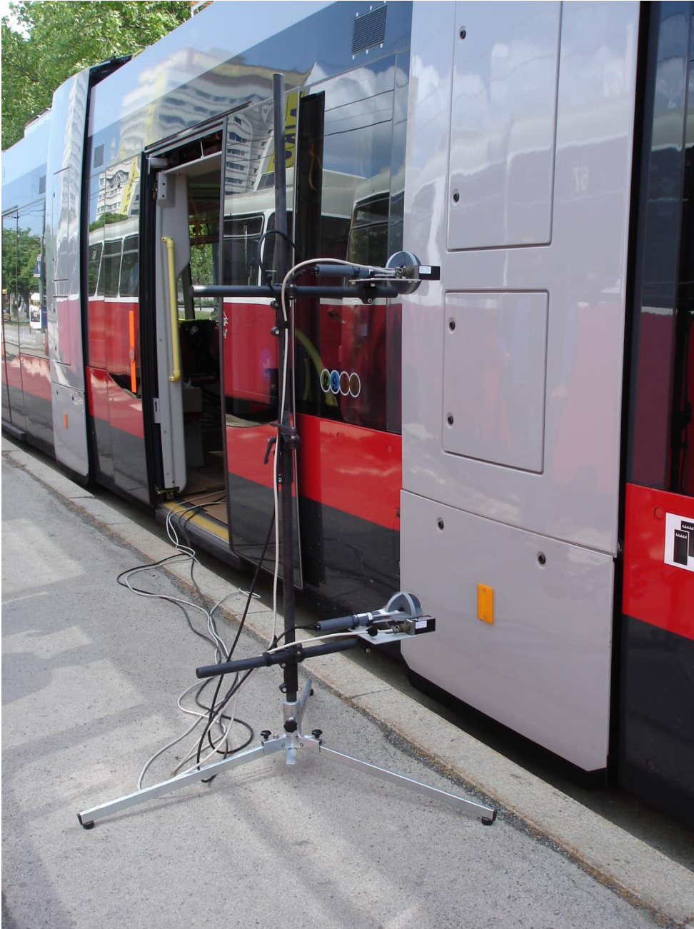
Abbildung 11-5: NFSB, DC-Fahrzeug, Außenbereich, Messung nach EN 50500
