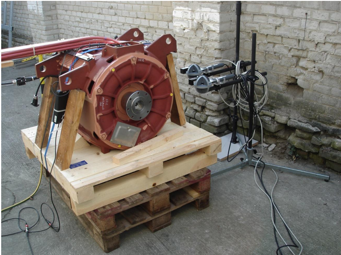
Abbildung 10-2: Magnetfeldmessung Traktionsmotor DC
