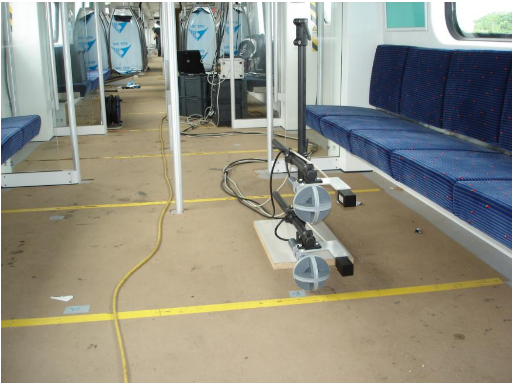
Abbildung 11-11: EMU, AC-Fahrzeug, Anordnung zur Messung nach Kundenforderung und zur Verifikation der Transformatorspezifikation(1)
