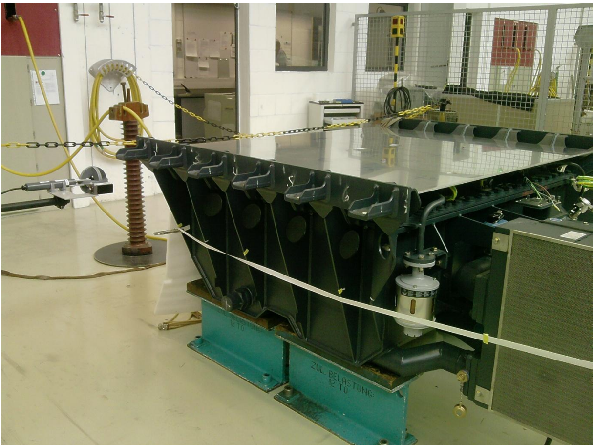
Abbildung 10-38: Transformator mit ALU-Schirmblech
