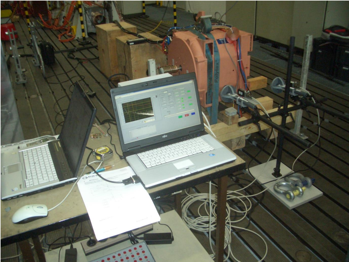
Abbildung 10-7: Messequipment, Traktionsmotor AC
