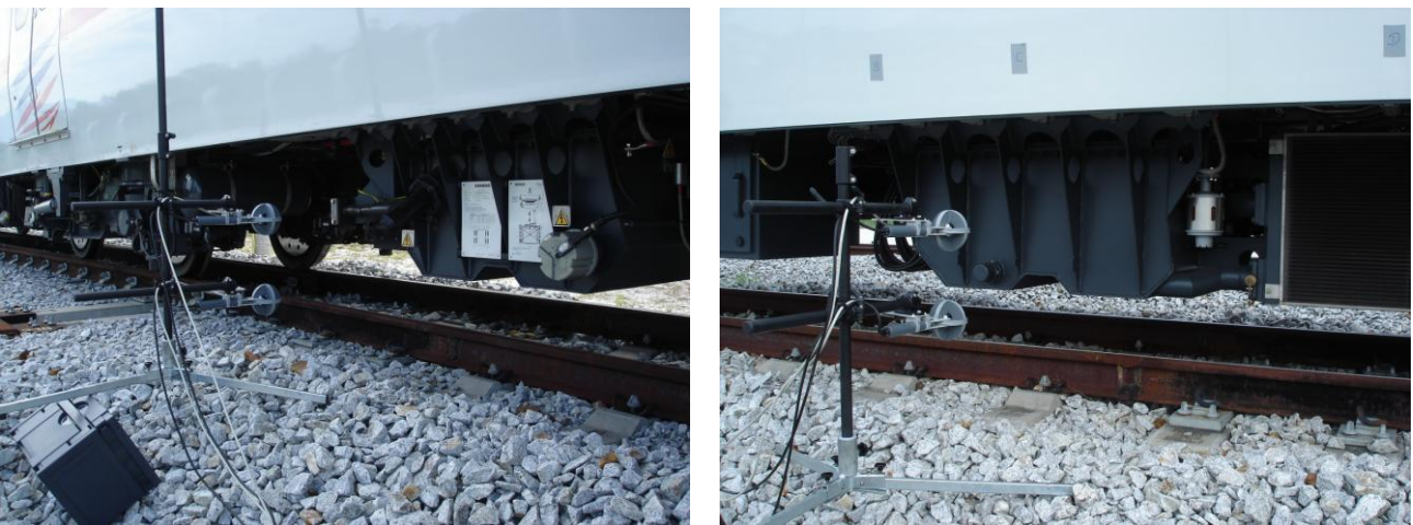
Abbildung 11-13: EMU, AC-Fahrzeug, Anordnung zur Messung nach Kundenforderung und zur Verifikation der Transformatorspezifikation
