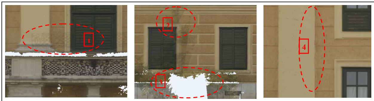
Abb.4-16: Bildfehler, entstanden bei der Orthophotoberechnung.
