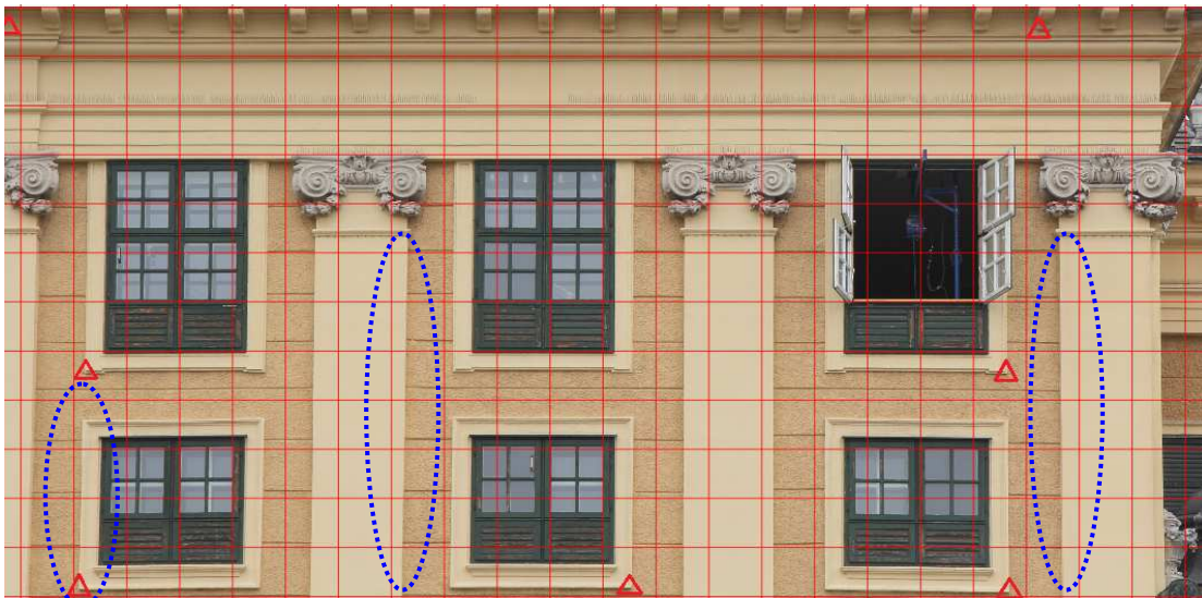
Abb.4-21: Ergebnis einer Entzerrung, mit relativ hohem Fehler. Deutliche Verkippungen bei vertikalen Linien sind zu erkennen (siehe Markierungen).
