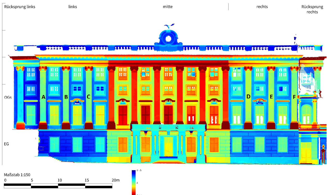
Abb.4-8: Z-Codierte Abstandskarte und Einteilung der Ostfassade Schönbrunn. Quelle: 4D-IT [38]
