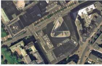
Abb.3-10: True Orthophoto – durch mehrere Aufnahmepositionen können Abschattungen berechnet und vermieden werden. Quelle: [27]
