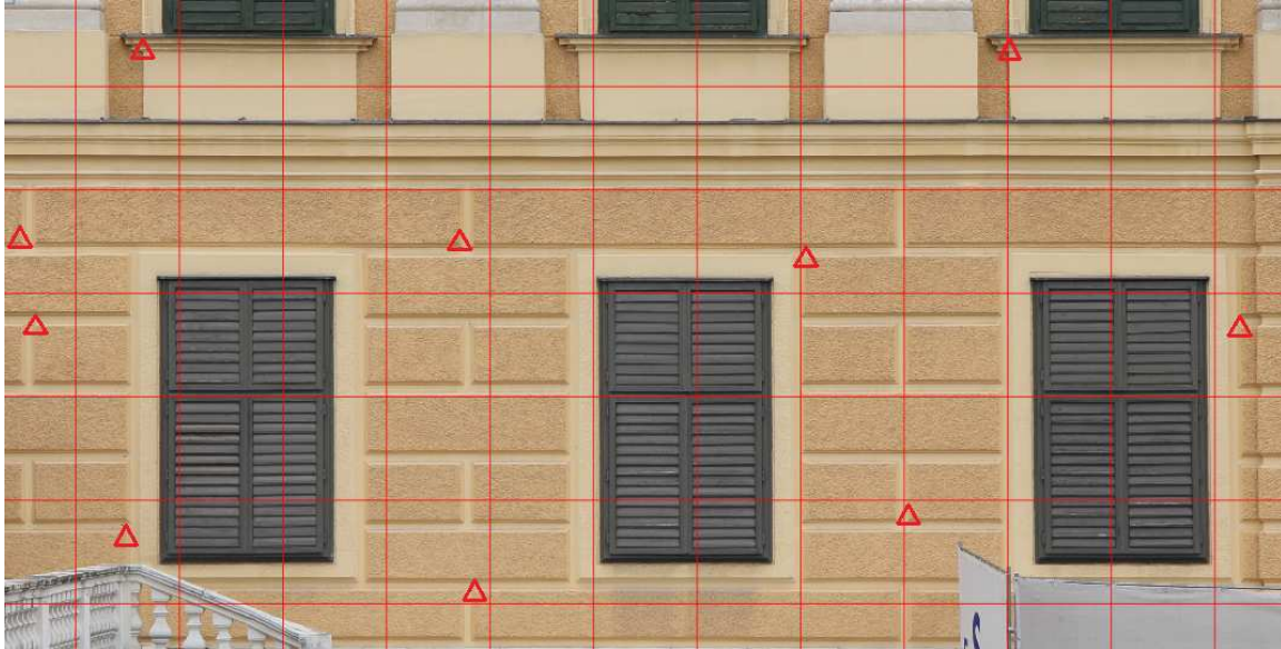
Abb.4-20: Gutes Entzerrungsergebnis und verwendete Kontrollpunkte (rote Dreiecke)
