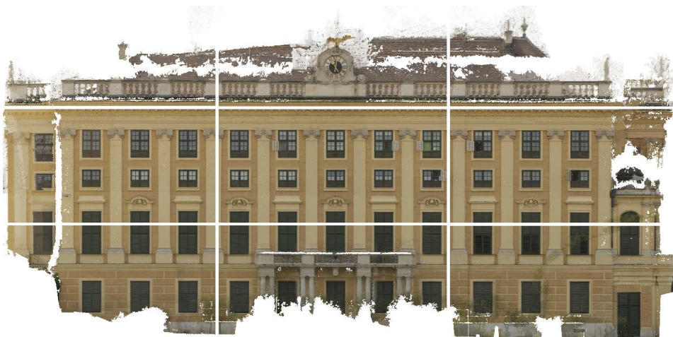
Abb.4-13: Fertig berechnetes Orthophoto und dessen Aufteilung in neun Teilbilder mit Pixelgröße 2mm.
