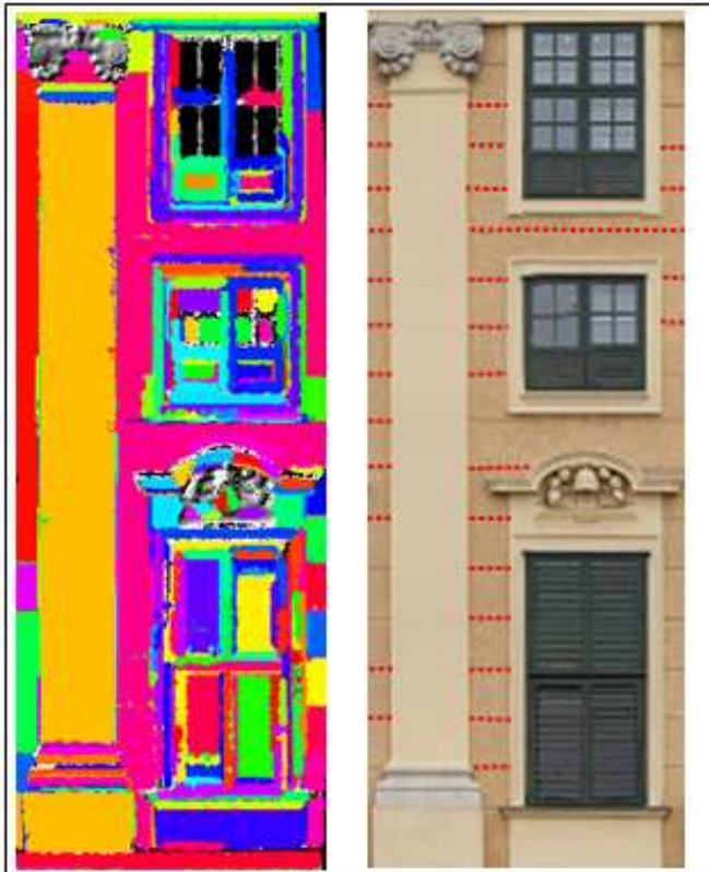
Abb.4-43: Vergleich der gefundenen Segmente zu Foto der Fassade: Es ist vor allem zu erkennen, dass die feine Unterteilung der Fassade nicht abgebildet werden konnte (siehe rote Markierungen rechts)
