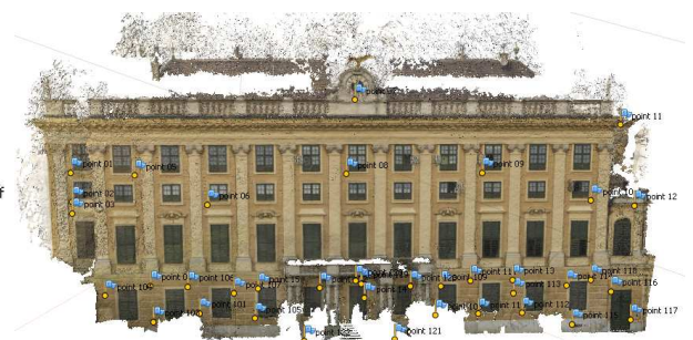
Abb.4-12: Errechnete Punktwolke und Verteilung der Kontrollpunkte
