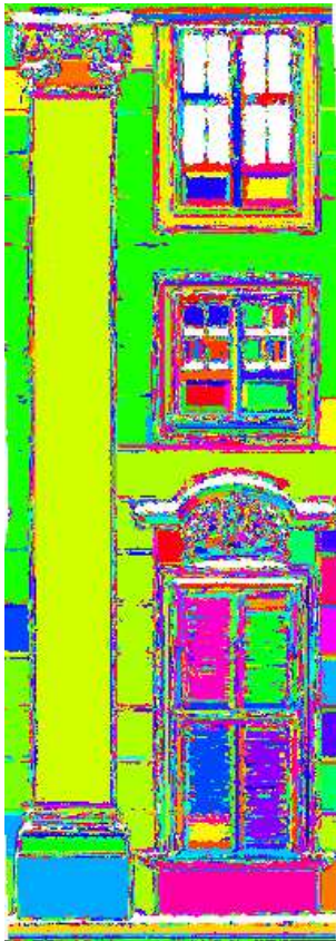
Abb.4-41: unübersichtliches Ergebnis der Segmentierung, ohne Filterung kleiner Segmente.
