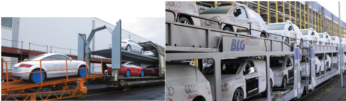
Abbildung 22: PKW-Verladung in geschlossene und Transport in offenen Doppelstockwaggons (aus Klug 2010 S.436 und BLG Logistik)
