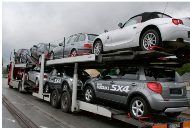
Abbildung 17: Doppelstöckiger offener LKW-Autotransporter (aus BLG 2014)
