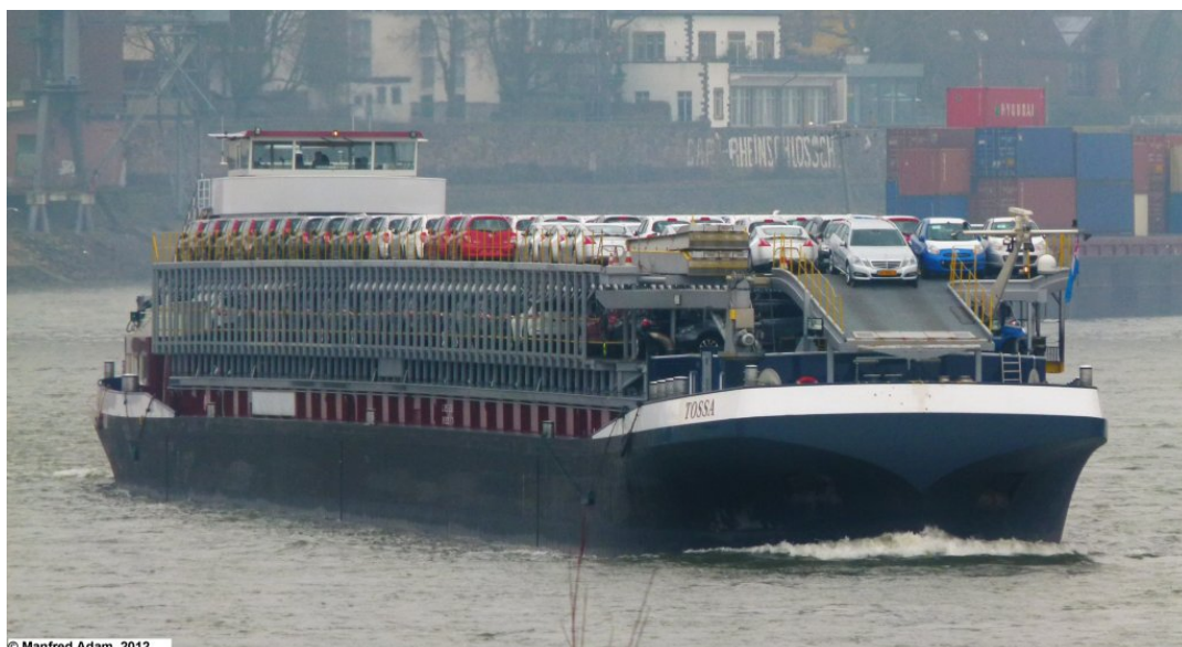
Abbildung 40: RoRo-Binnenschiff Barco auf dem Rhein im Einsatz für Ford (aus Ford 2011)
