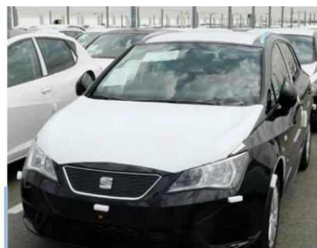
Abbildung 23: Teilweiser und "full body" Transportschutz (aus Finished Vehicle Magazin 2/2012, S.56)
