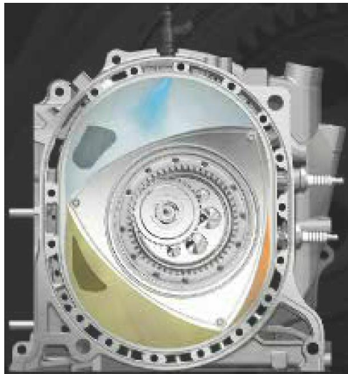
Abbildung 2.5 Wankelmotor mit homogener Benzindirekteinspritzung [4]
