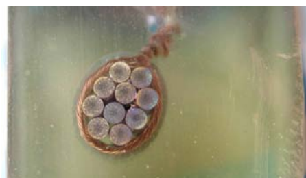
Abb. 2.8: In Epoxidharz eingebettetes und mittels Kupferlitze kontaktiertes Lotbündel.
