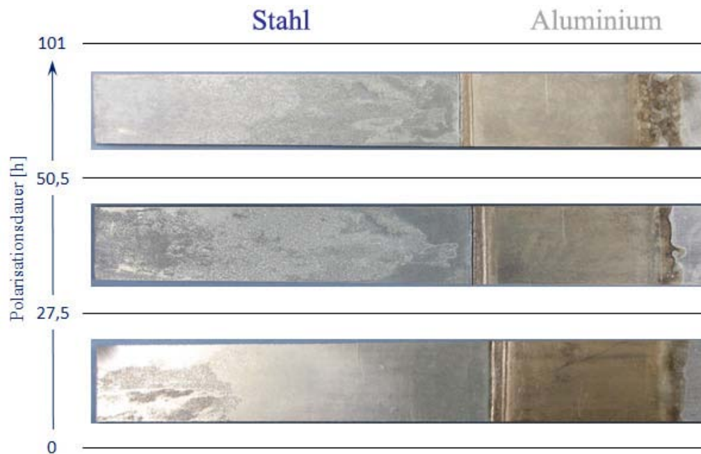
Abb. 3.51: Versuch 1, Probenblech B ( j_P = 0,50 \text{ mA/cm}^2 bezogen auf die Oberfläche der Schweißraupe). Versuch 1, Probenblech B: Vorderseite und Rückseite der Polarisationsprobe.
