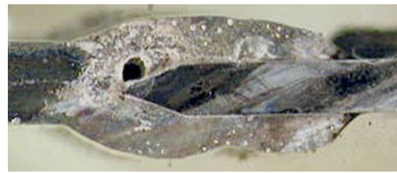
(b) Probe 7. Potenzialfenster: 200/-700 mV.
