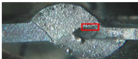
Abb. 3.12: Probe 561. Elektrolytlösung: NaCl 5 m%. Potenzialfenster: +900 mV bis -900 mV. Zyklenzahl: 6
