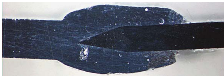
Abb. 3.38: Probe 213 nach 2-wöchiger Auslagerung im Salzsprühtest. Lichtmikroskopische Aufnahme des Querschliffs.
