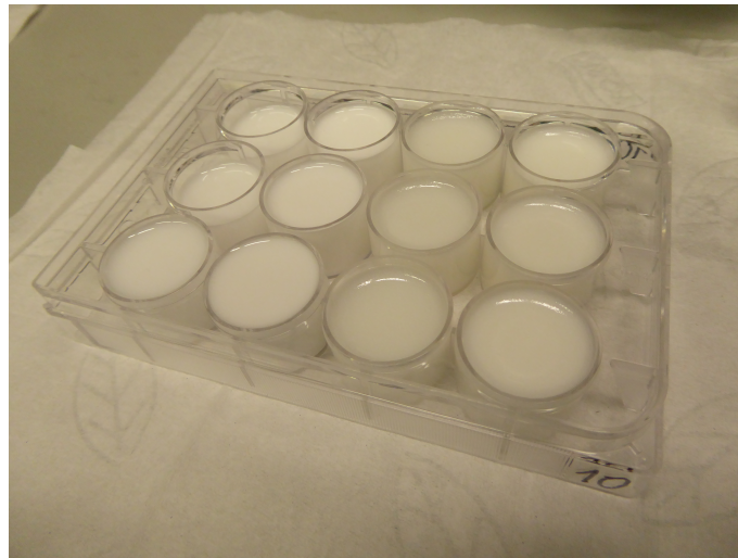
Abbildung 3.9: Silikonphantom mit Titandioxid in einer Mikrotiterplatte
