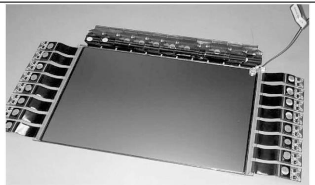
Abbildung 17: Amorphes Selen Flat Panel Detektor aus (Yaffe and Mainprize, 2004).
